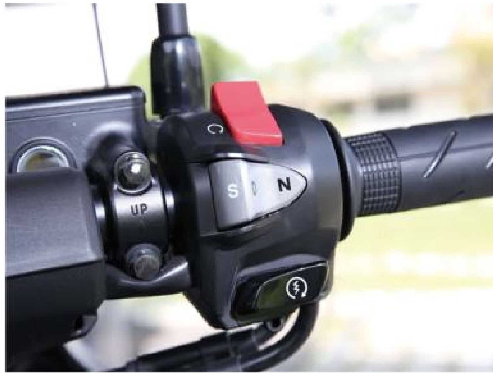
▲右把手控制界面讓駕駛可迅速的於空檔、D 檔與 S 檔位中切換。
