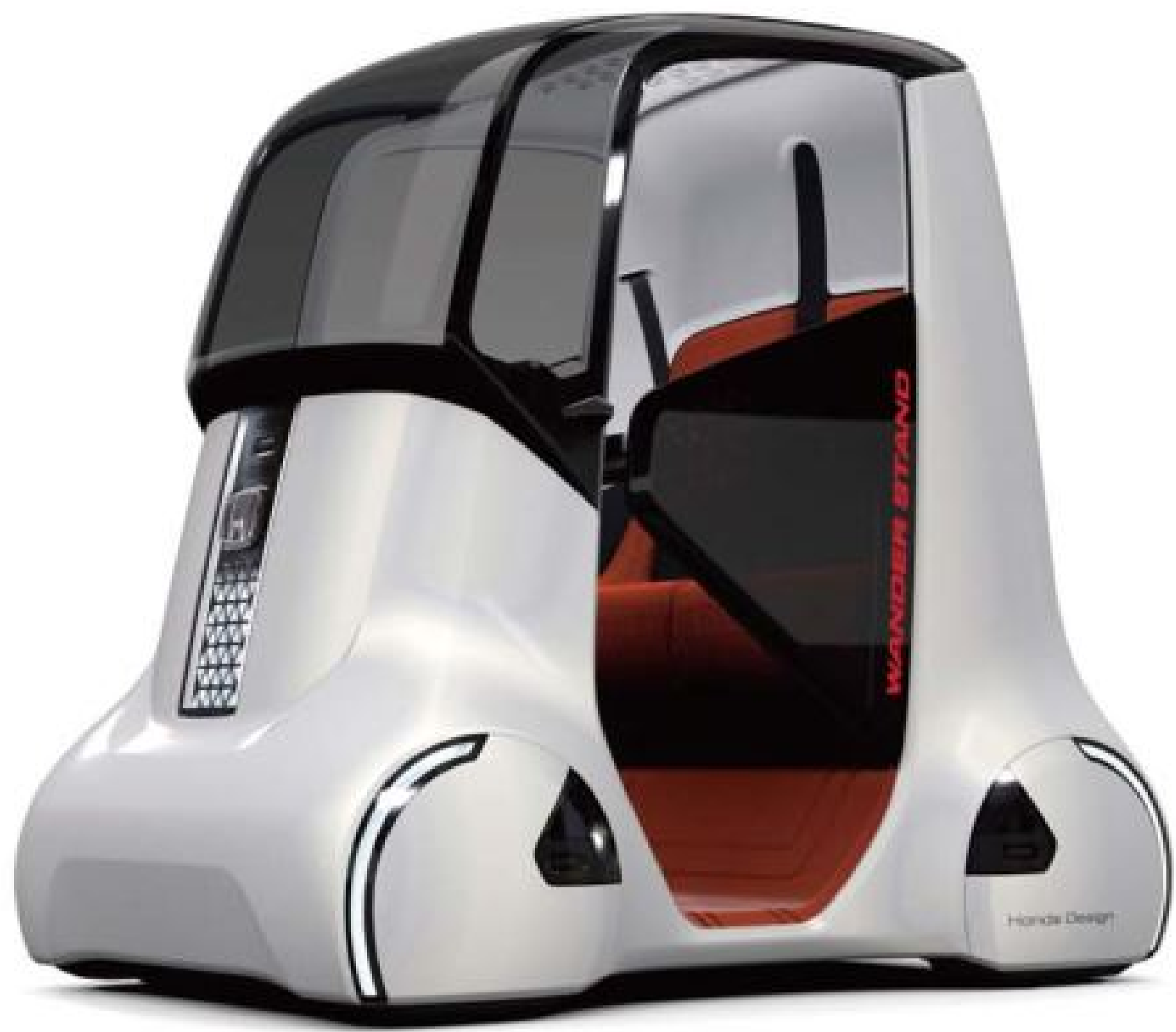
▲ Wander Stand Concept 具有雙人座位的開放式車身，車門以三角形透明材質代替。
