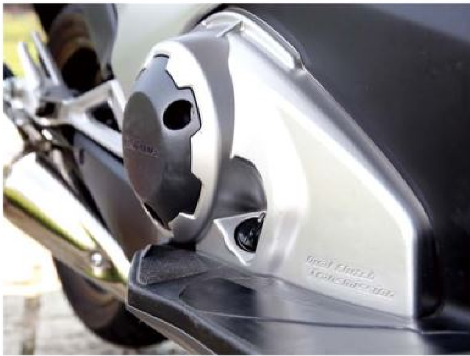
▲變速箱外殼清楚說明，NC750D 搭載的正是 Honda 的先進 DCT 雙離合器變速科技。
