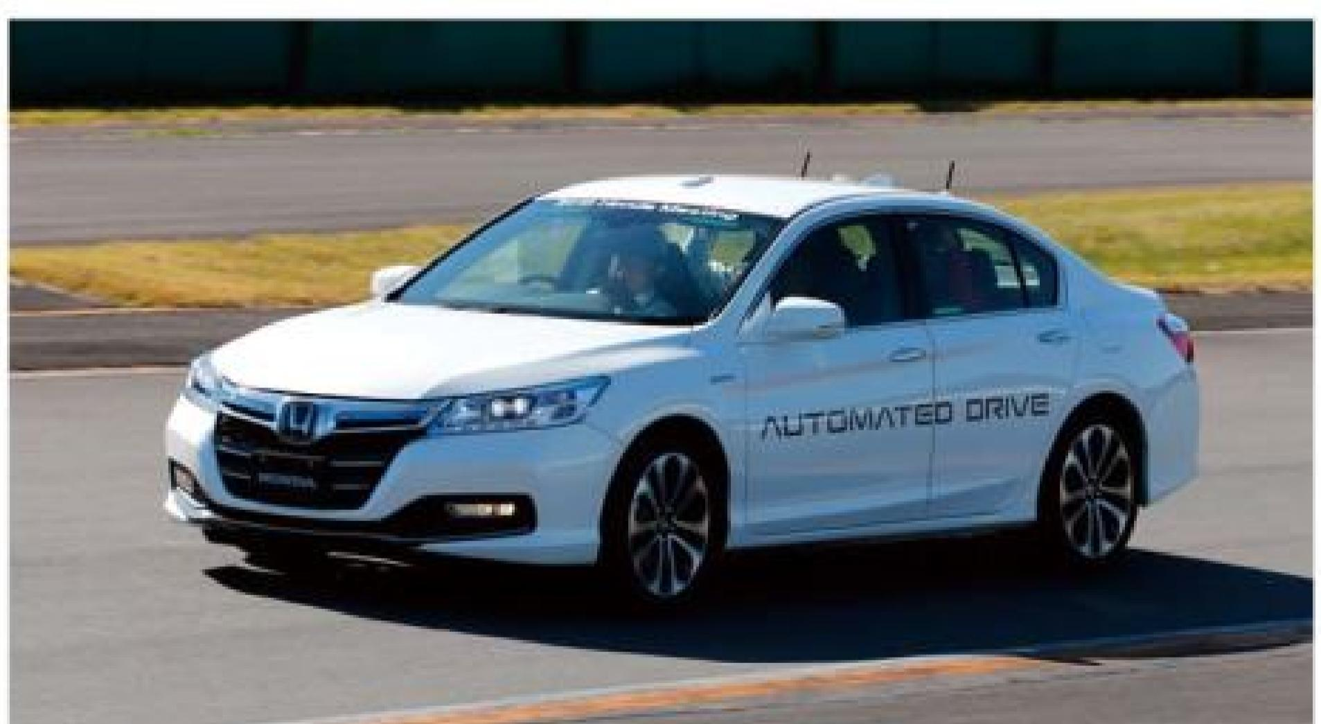
▲要達成精準的路線判斷，Automated Drive 內含 GNSS 全球導航衛星系統及高精度定位圖資與路線辨識等技術，更需要 360 度物體偵測、路線規劃與車輛動態控制等科技的輔助。
