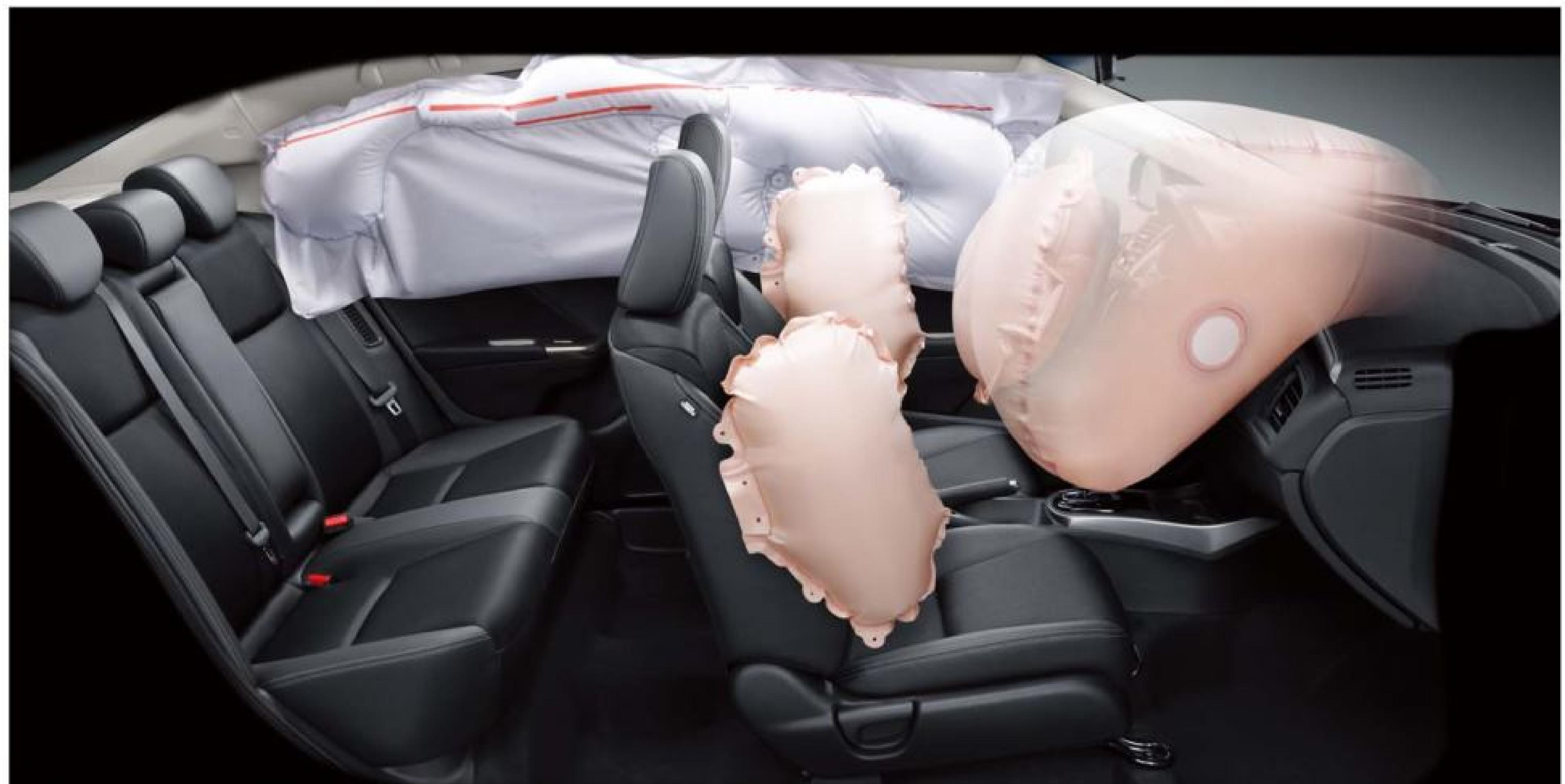
▲頂級車型 VTi-S 擁有雙前座輔助氣囊、雙車側輔助氣囊以及雙側氣簾，共同構建出最完備且周全的嚴密屏障。
