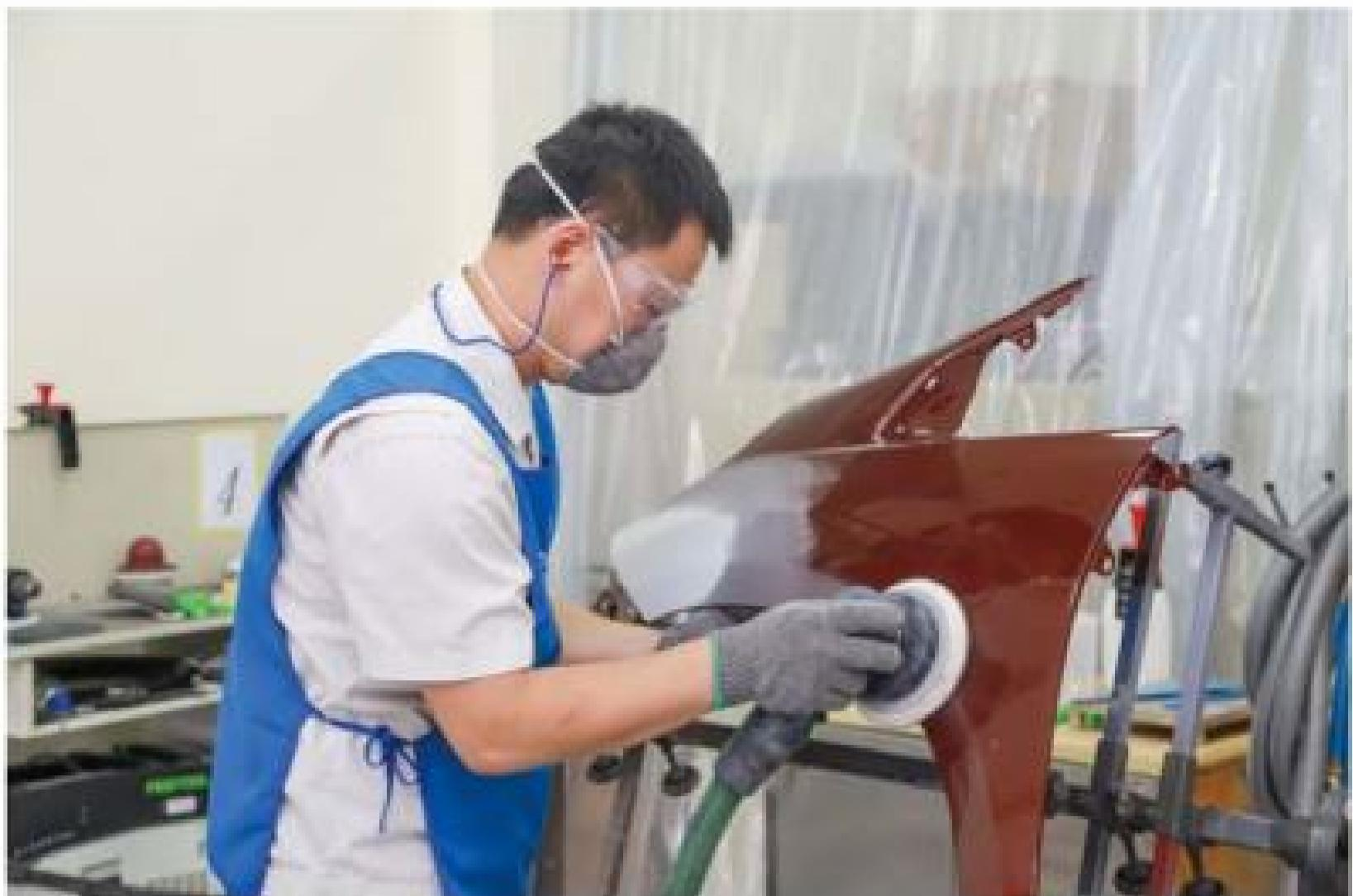
▲塗裝測驗則由整平葉子板表面開始，噴漆運用方式與量色技巧是檢驗重點。
