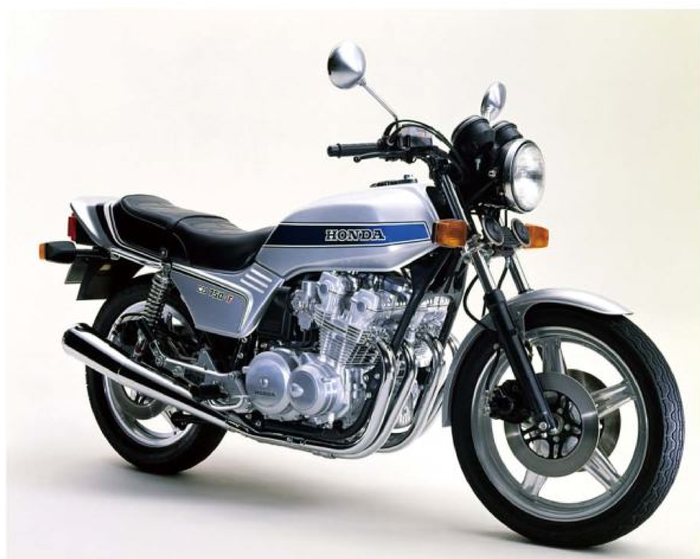
▲ 1979 年問世的 CB750F 搭載四缸 DOHC 16V 引擎，具備 68ps 最大馬力輸出，配置雙前碟煞、後碟煞與四合二排氣尾管設計，成為當時最為運動化的 CB 車系代表。
