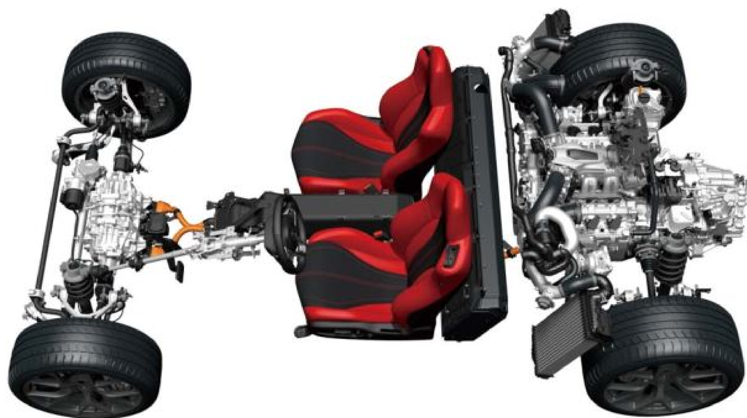
▲全新 NSX 除了中置引擎之外，還增加三具電動馬達，成為油電混合動力超級跑車。
