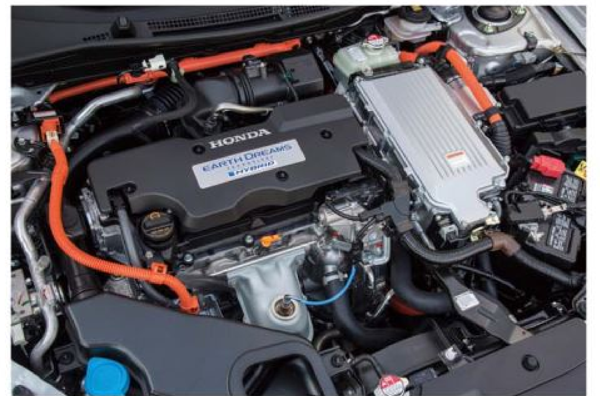
▲ Accord HYBRID 搭載 Honda 全新開發的 SPORT HYBRID i-MMD 油電混合系統，會依駕駛情況與路況切換模式，以獲得最佳的動力輸出與最高燃油效率。
