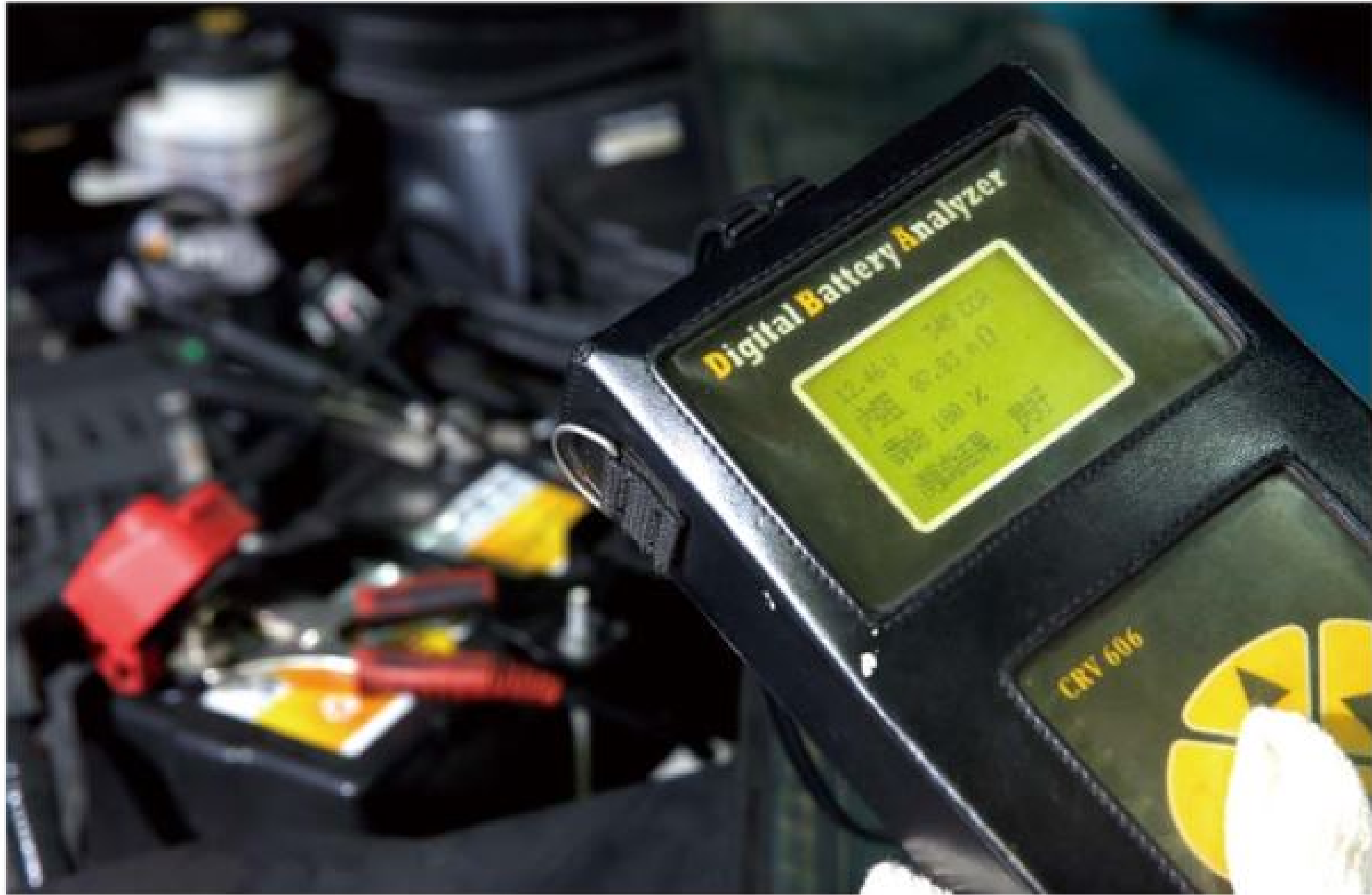
▲電瓶更換前，需以專業儀器判讀數據，確認電瓶的狀況。
