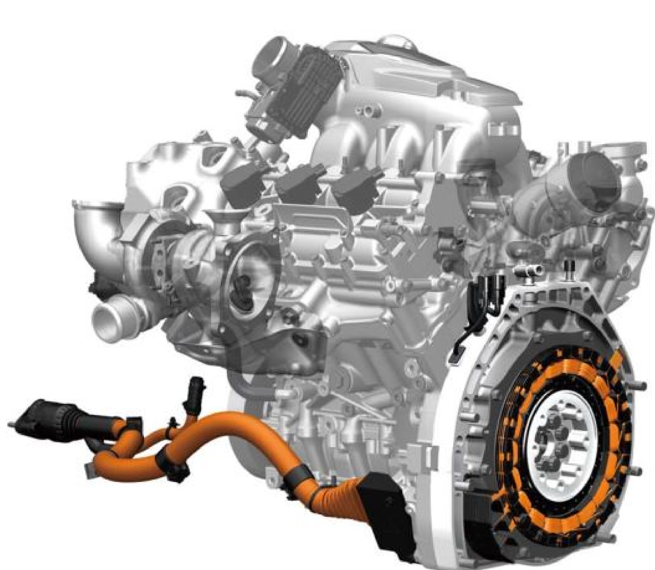
▲ NSX 的雙渦輪增壓 V6 引擎和直接傳動馬達，是 Sport Hybrid SH-AWD 系統的核心。
