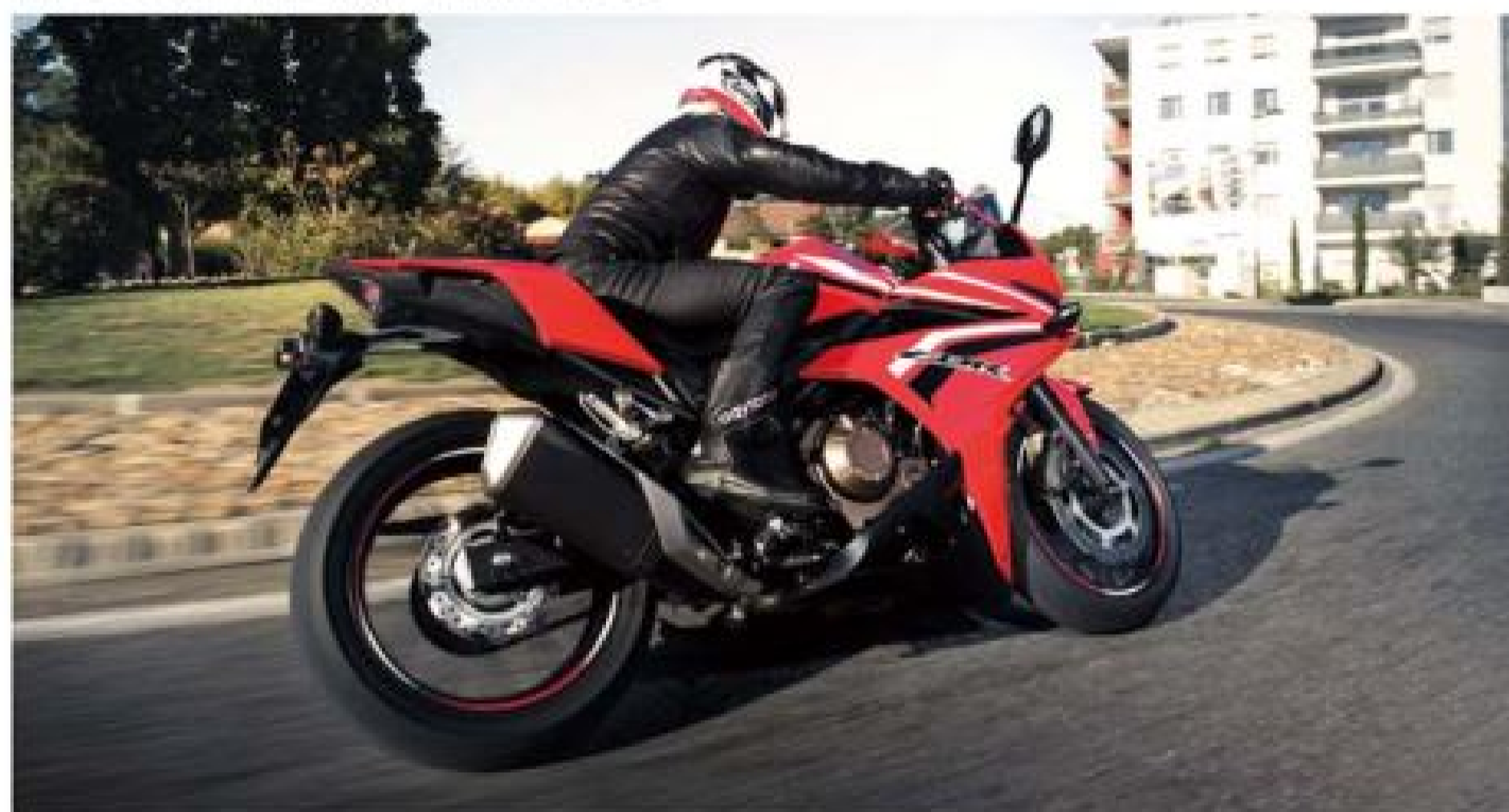
▲前潛望正立式預載可調油壓前叉搭配後多連桿中置九段預載可調避震，提供更細膩的行路表現。
