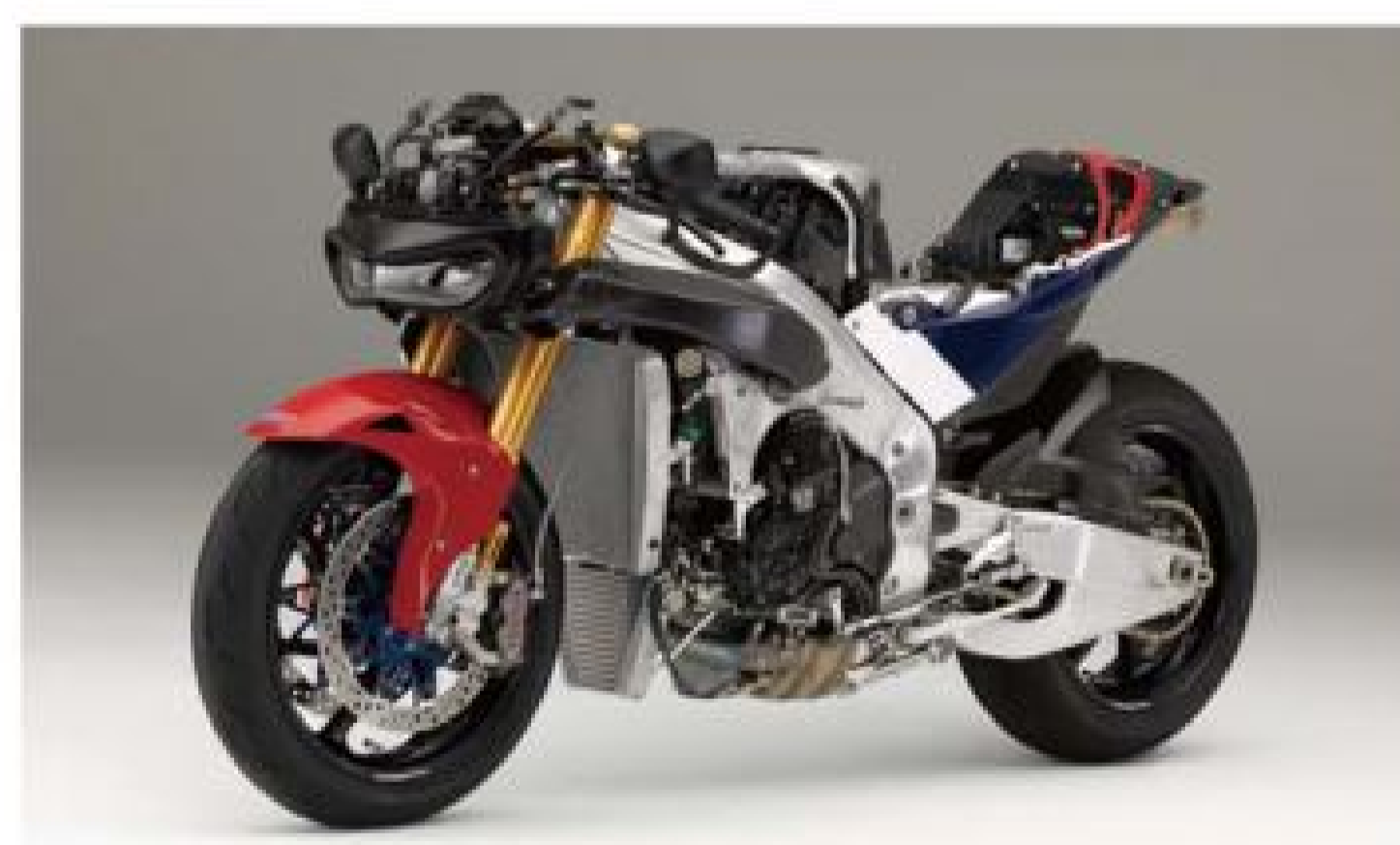
▲ NR750 是為了挑戰 GP 賽事而研發的車款，最大特色就是橢圓形活塞，讓每個汽缸內能容納八個汽門，進而提升馬力。
