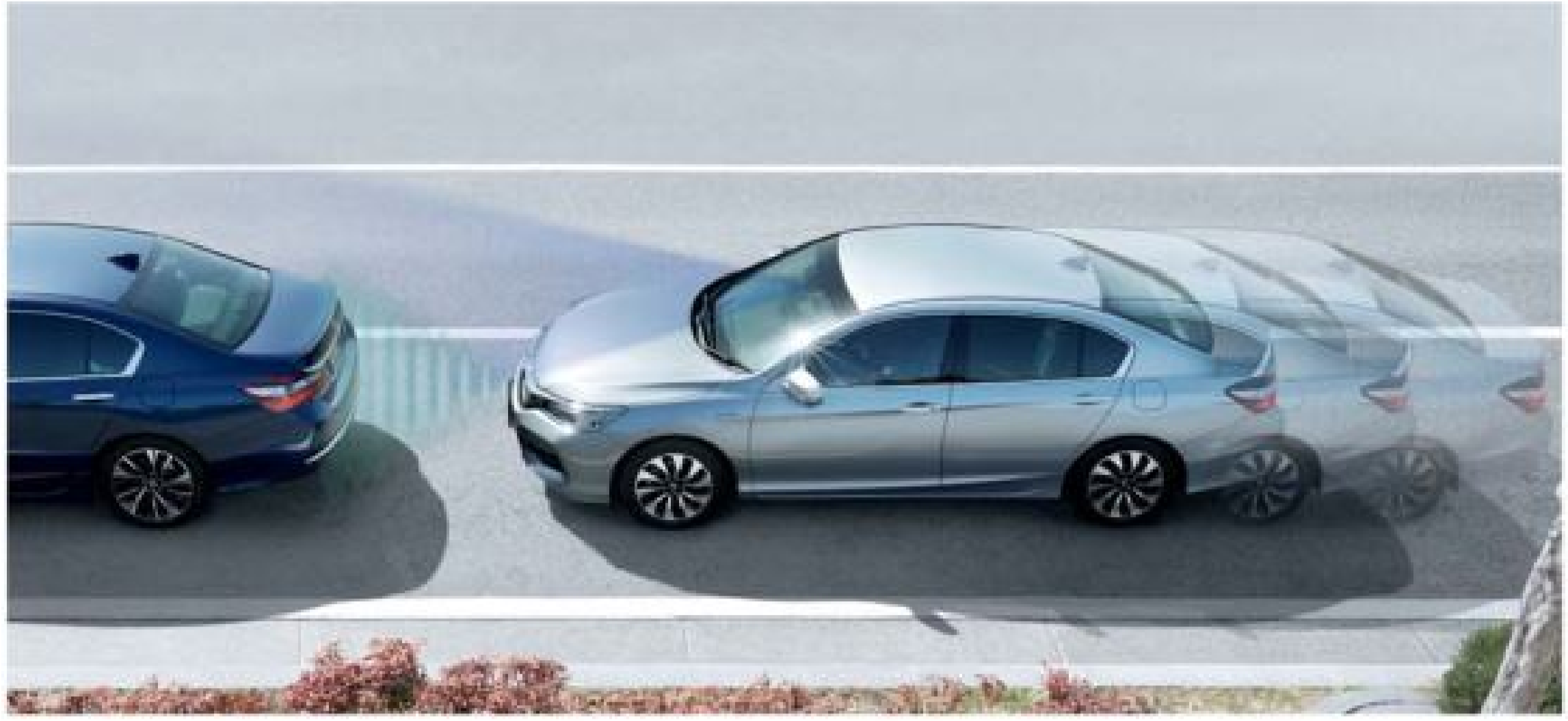
▲當碰撞風險增加時系統進行預煞甚至自動煞車的「CMBS 碰撞緩解煞車系統」，確保行車時萬無一失的保障。
