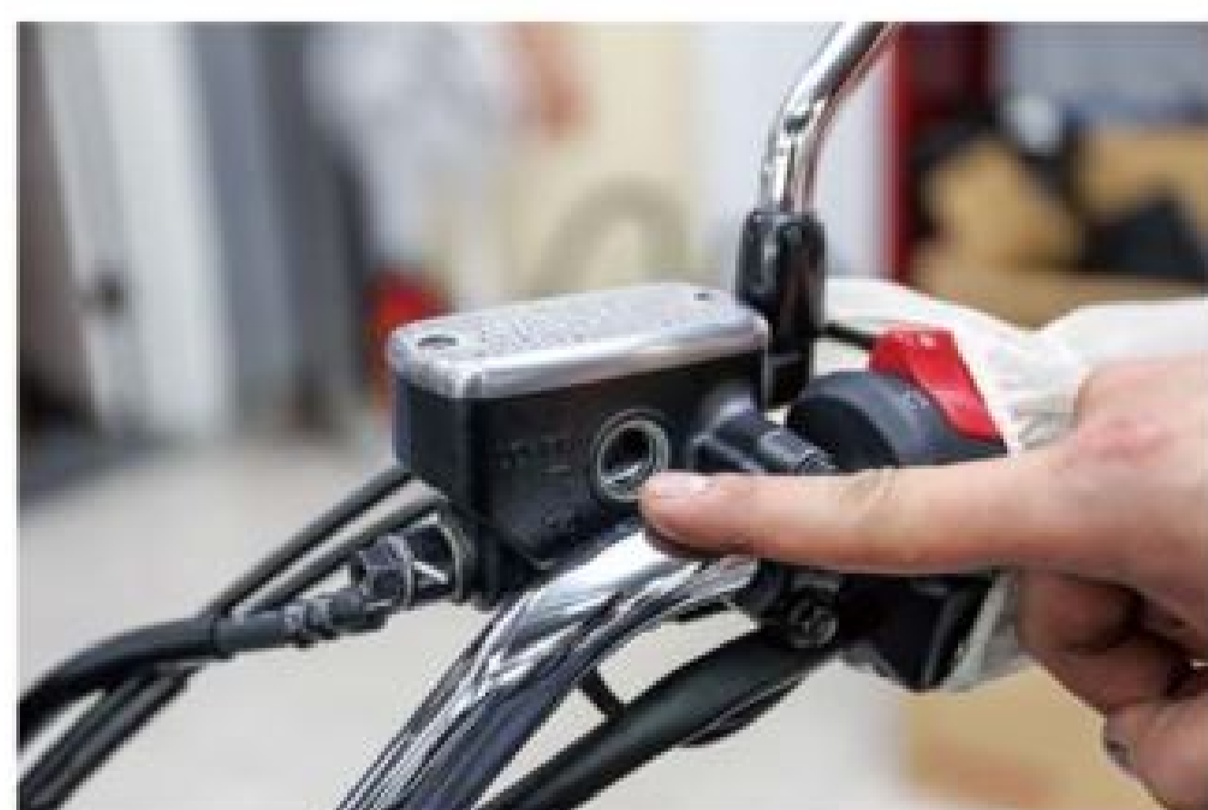
▲ 目視的方式就可以了解煞車油是否足夠。
