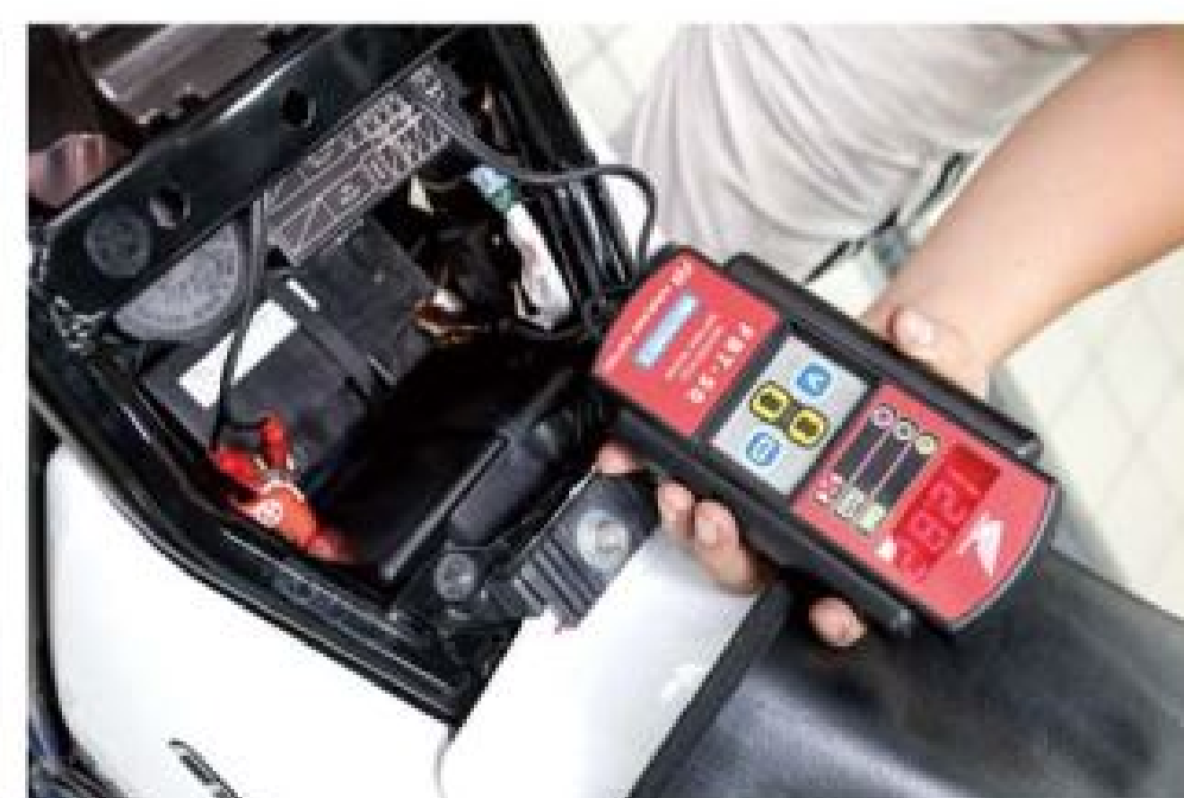
▲ 如有電壓表也可自行測量電瓶的狀況良窳。
