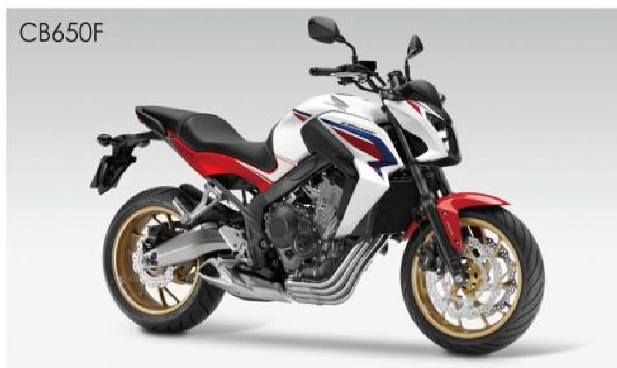
▲ CB650F/CBR650F 車系搭載排氣量 649c.c 水冷並列四汽缸引擎，集合出色性能與均衡操控於一身，雖有不同騎乘位置設定則但皆相當受騎士喜愛。
