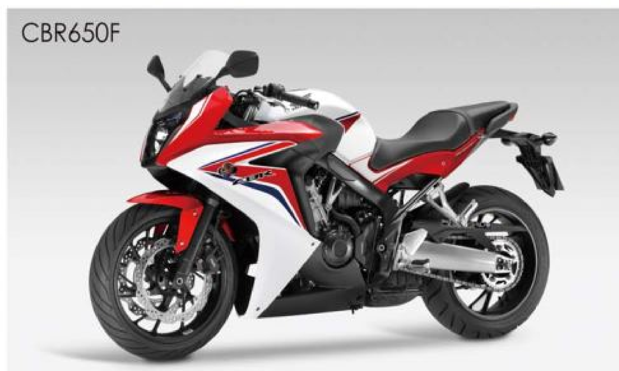
▲ CB650F/CBR650F 車系搭載排氣量 649c.c 水冷並列四汽缸引擎，集合出色性能與均衡操控於一身，雖有不同騎乘位置設定則但皆相當受騎士喜愛。
