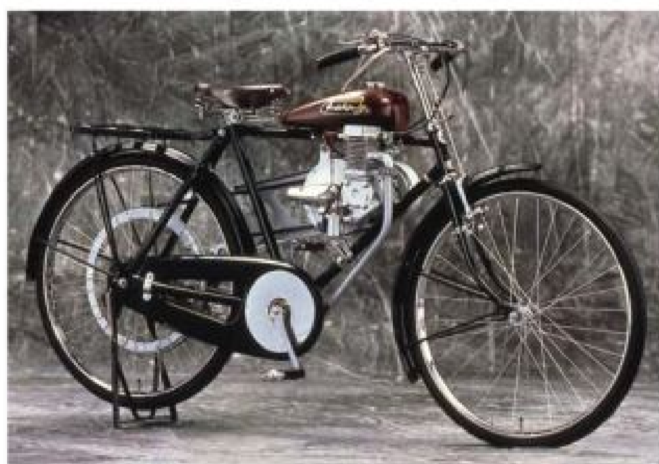
◀ Honda 第一款成車產品：Model A，是將軍方釋出的小型引擎經過當時「Honda 技術研究所」改造後，加裝在腳踏車上而成。
