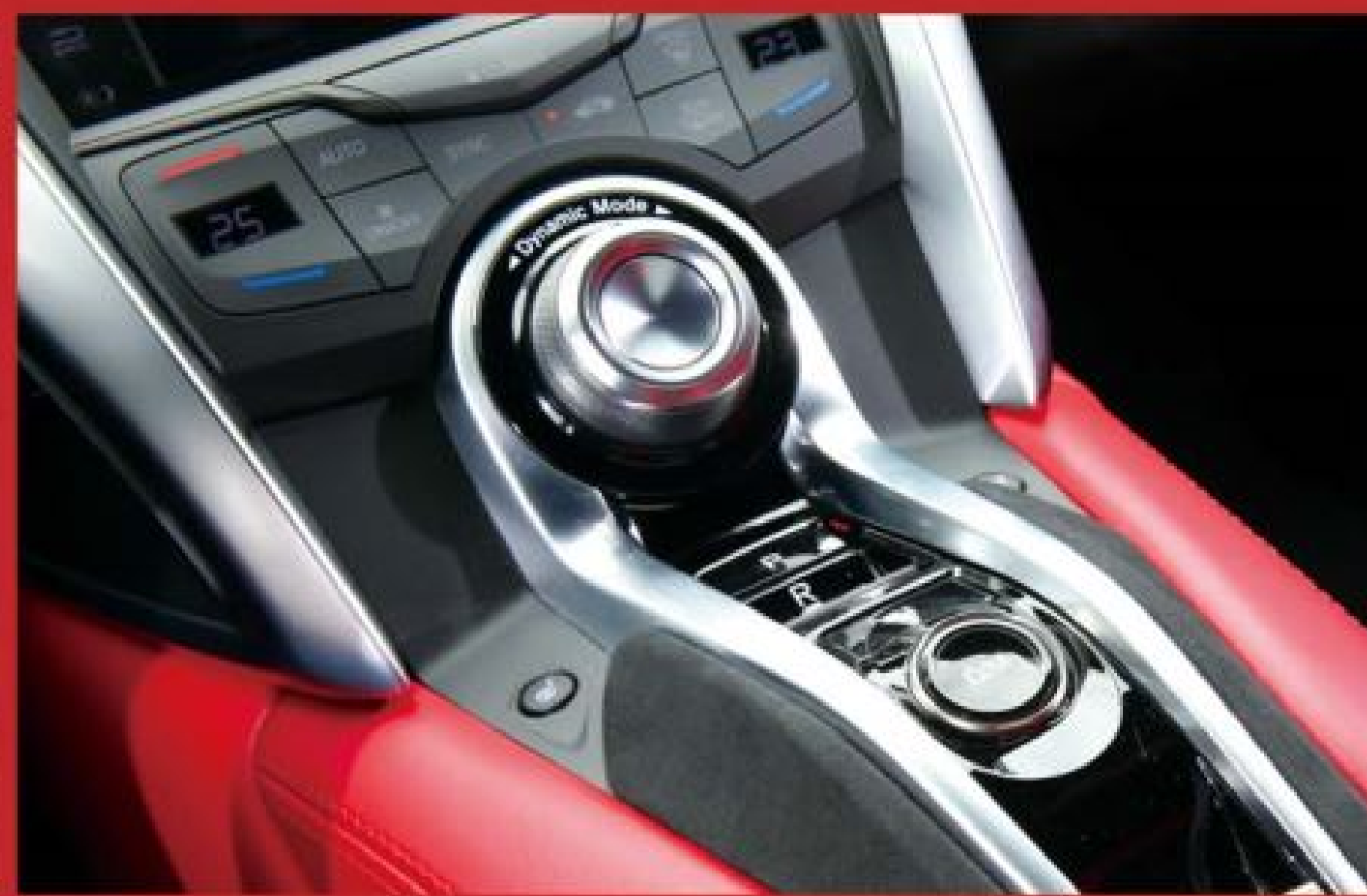
▲ NSX 採電子檔位選擇設計，直接在鞍部將 P、R、N、D / M 檔位以按鈕方式個別呈現，電子式駐車檔則在最後方。
