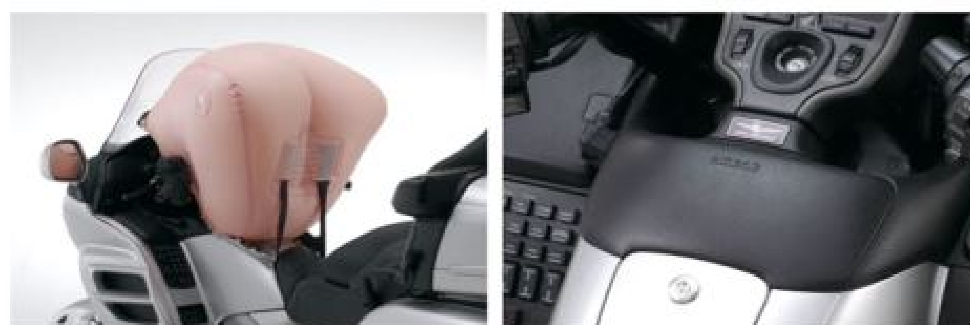
▲2005 年，Honda 研發出世界第一款摩托車專用輔助氣囊，2006 年上市的 GL1800 GOLDWING 便搭載這項技術。
