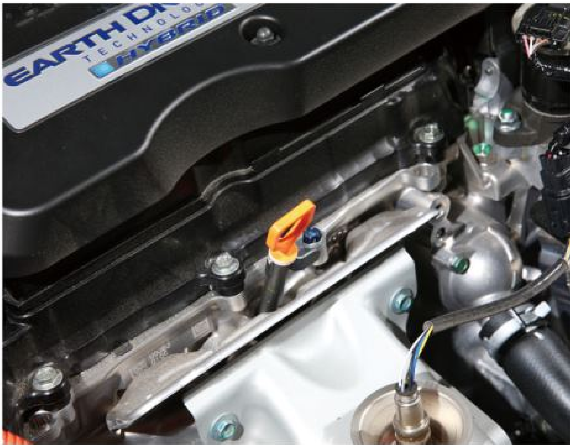
▲機油、變速箱油、煞車油、動力方向機油均可透過油尺檢測液面高度是否正常。
