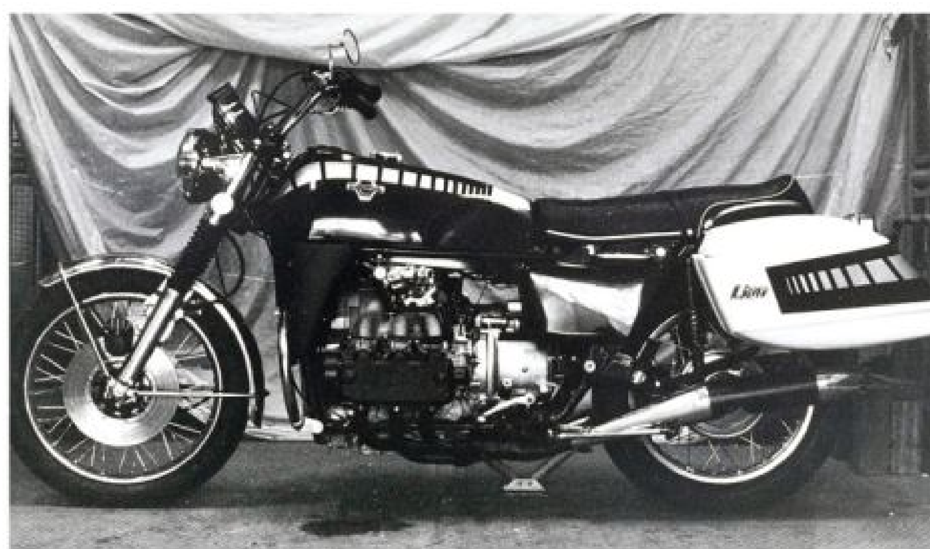
▲由入交召一郎帶領的團隊在 1972 年推出 GOLDWING 前身：M1（計畫編號 371），擁有水平對臥六汽缸引擎與 1,470c.c. 排氣量。
