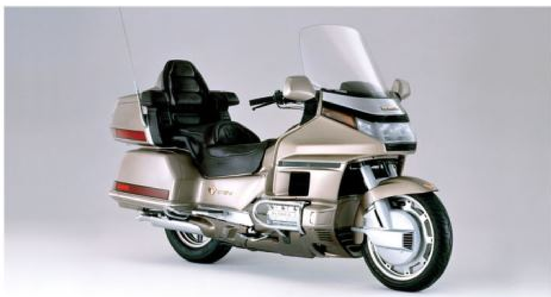
▲來到西元 1988 年，GL 1500 GOLDWING 搭載了排氣量 1,520c.c. 的水平對臥六汽缸引擎，終於呼應了 M1 原型車的開發理念，而同年也是此車系首次在日本上市。
