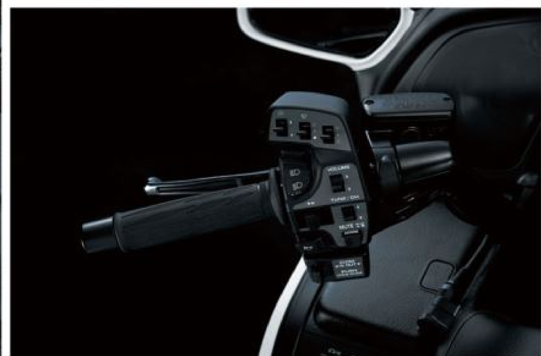
▲ 左右側把手的控制開關，設計直覺簡易，騎士能以最順手的方式調整。
