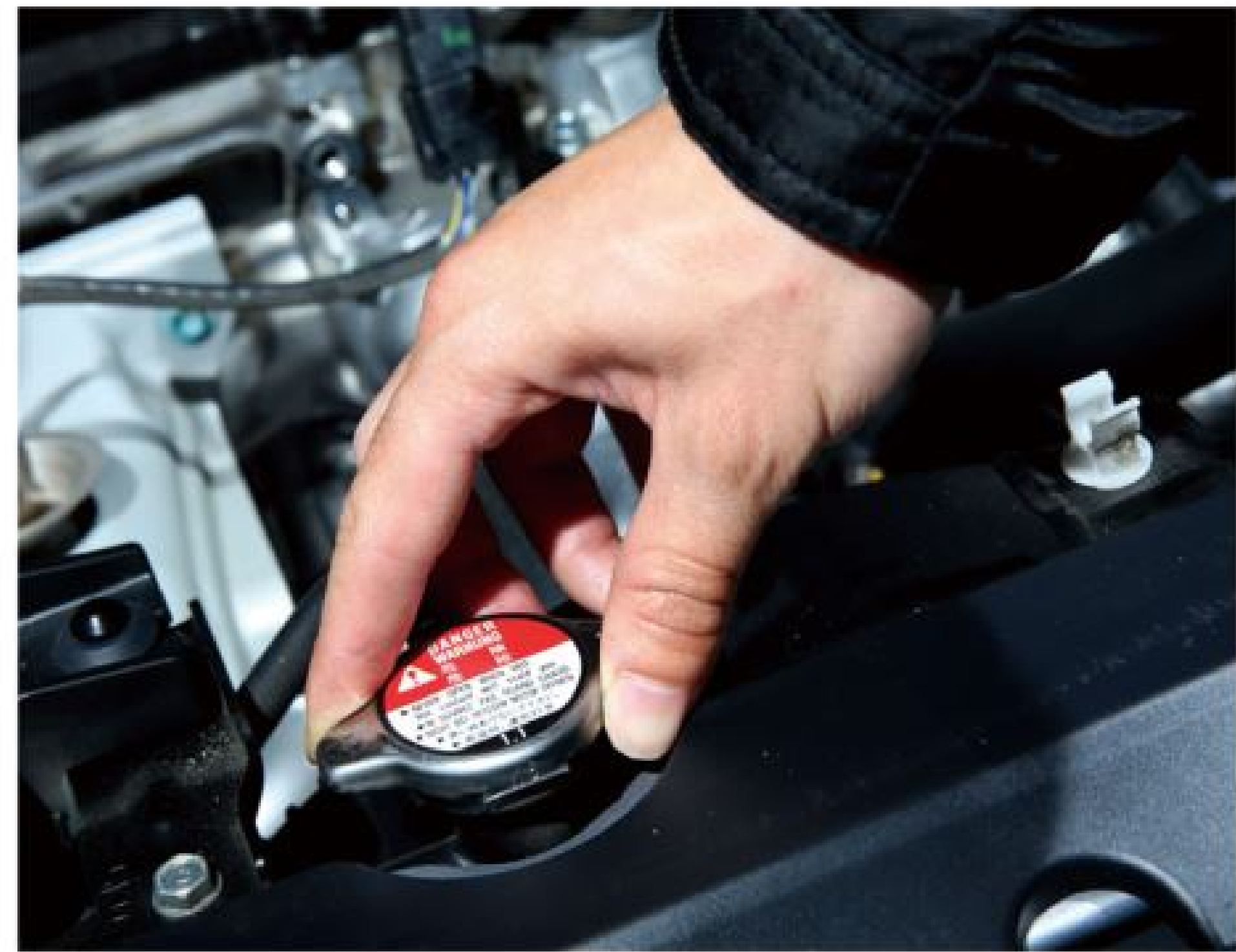
▲水箱水負責動力系統的冷卻，切記需於冷車時方可開啟水箱蓋確定主、副水箱水位是否正常。
