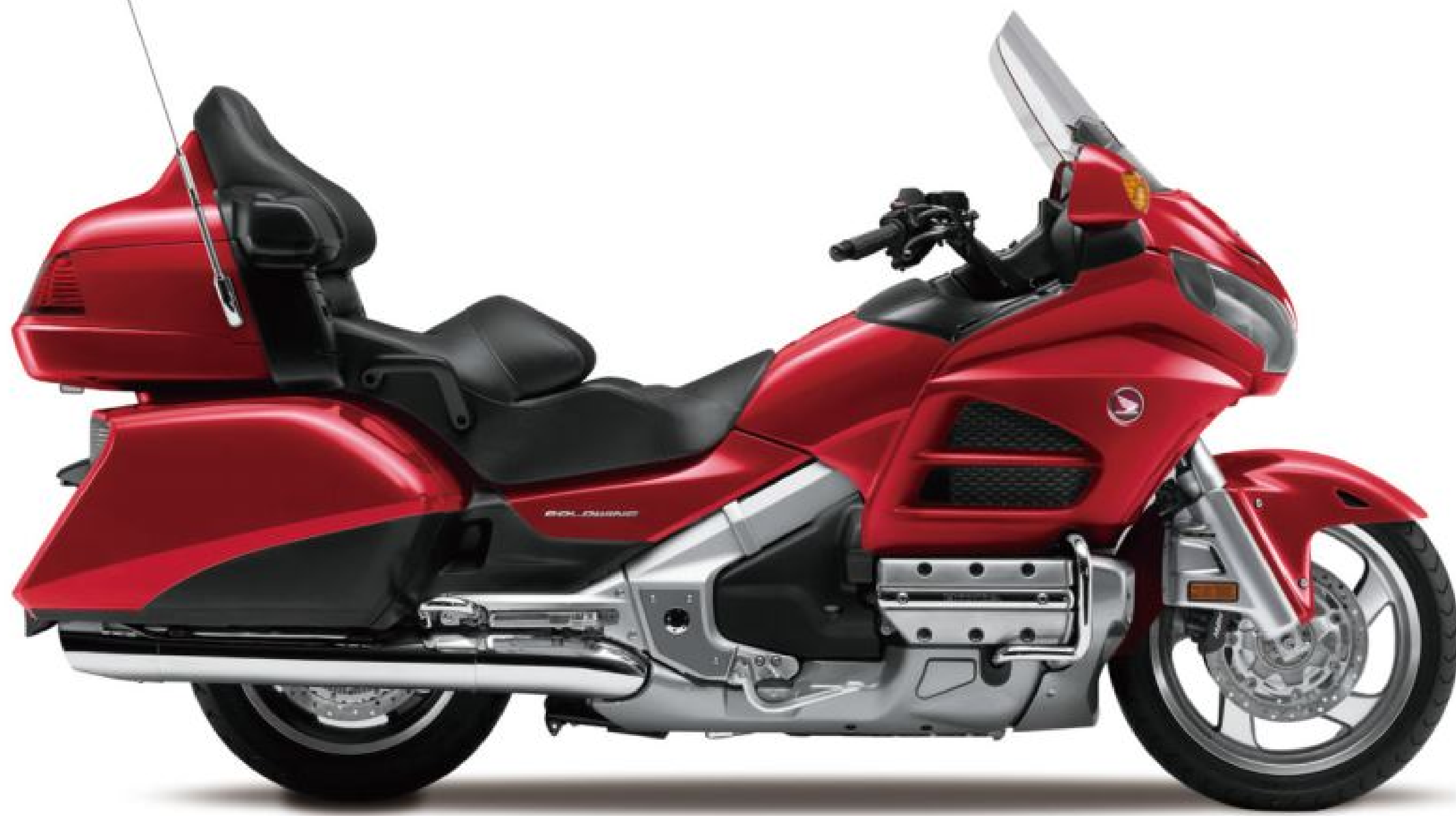
▲ 2017 年式 GOLDWING 擁有 2,630×945×1,455mm 的車身尺碼，搭配 1.8 升水平對臥汽油引擎，「The King of Motorcycles」封號實至名歸。
