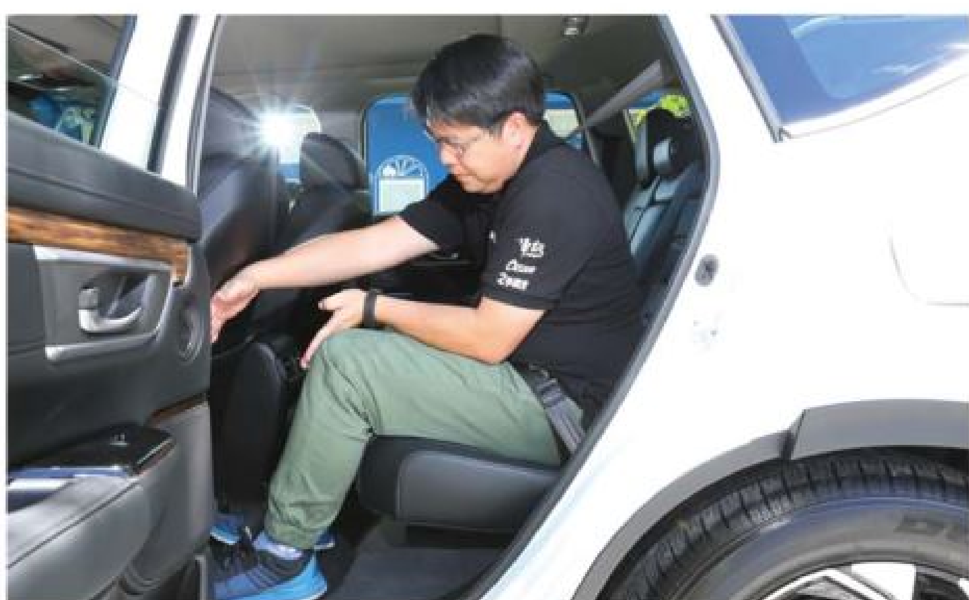
▲在軸距加長 40mm 且膝部空間較上代車型增加 65mm 的情況下，後座擁有相當寬敞的空間。
