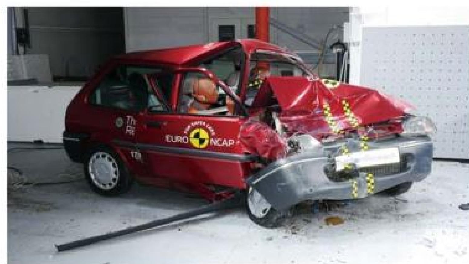
▲ 1997 年的 Rover 100，在時速 40 英哩進行偏位撞擊時，整部車的扭曲變形都相當嚴重。
