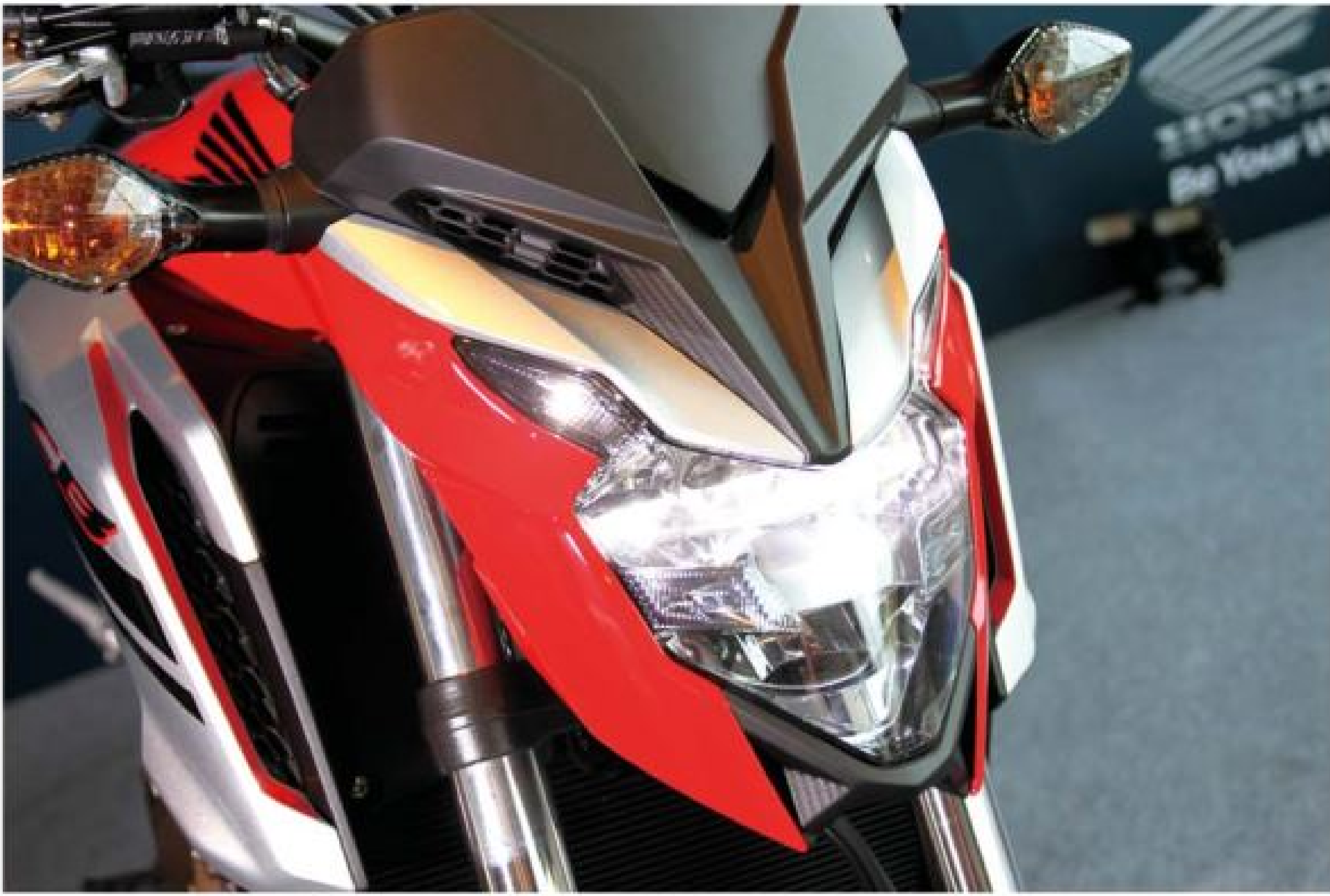
▲街車定位的 CB650F 改配置 LED 大燈，小型化的燈具與更具線條的胸蓋設計，亦優化了進氣效果。
