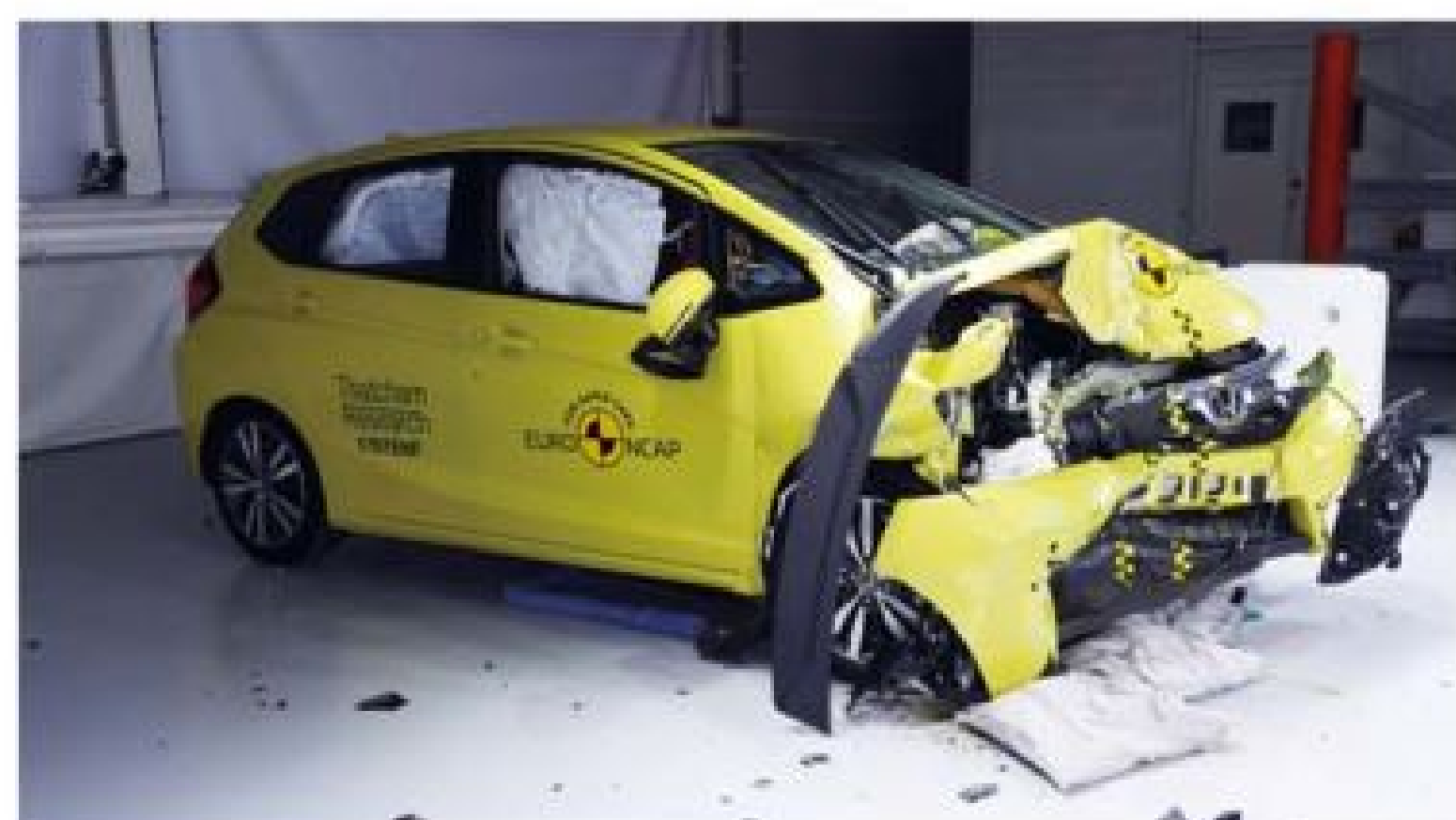
▲ Honda Jazz (FIT) 的引擎室毀損程度不輕，但完全沒有壓迫到車廂空間，車體也幾乎沒有變形。
