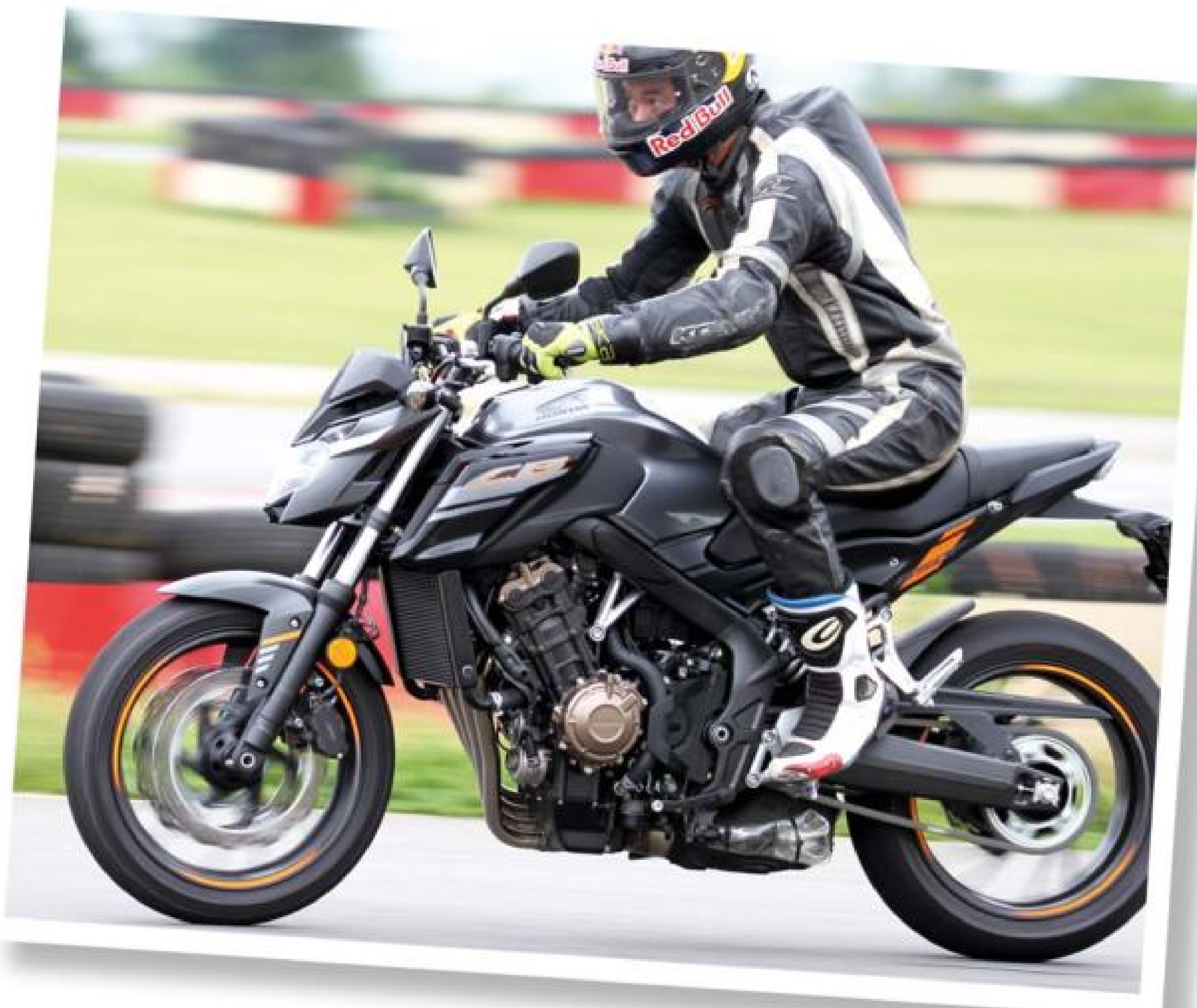
▲ CB650F 的改款重點，則另包含把手位置更動以優化減震效果，以及全新設計的煞車卡鉗等。
