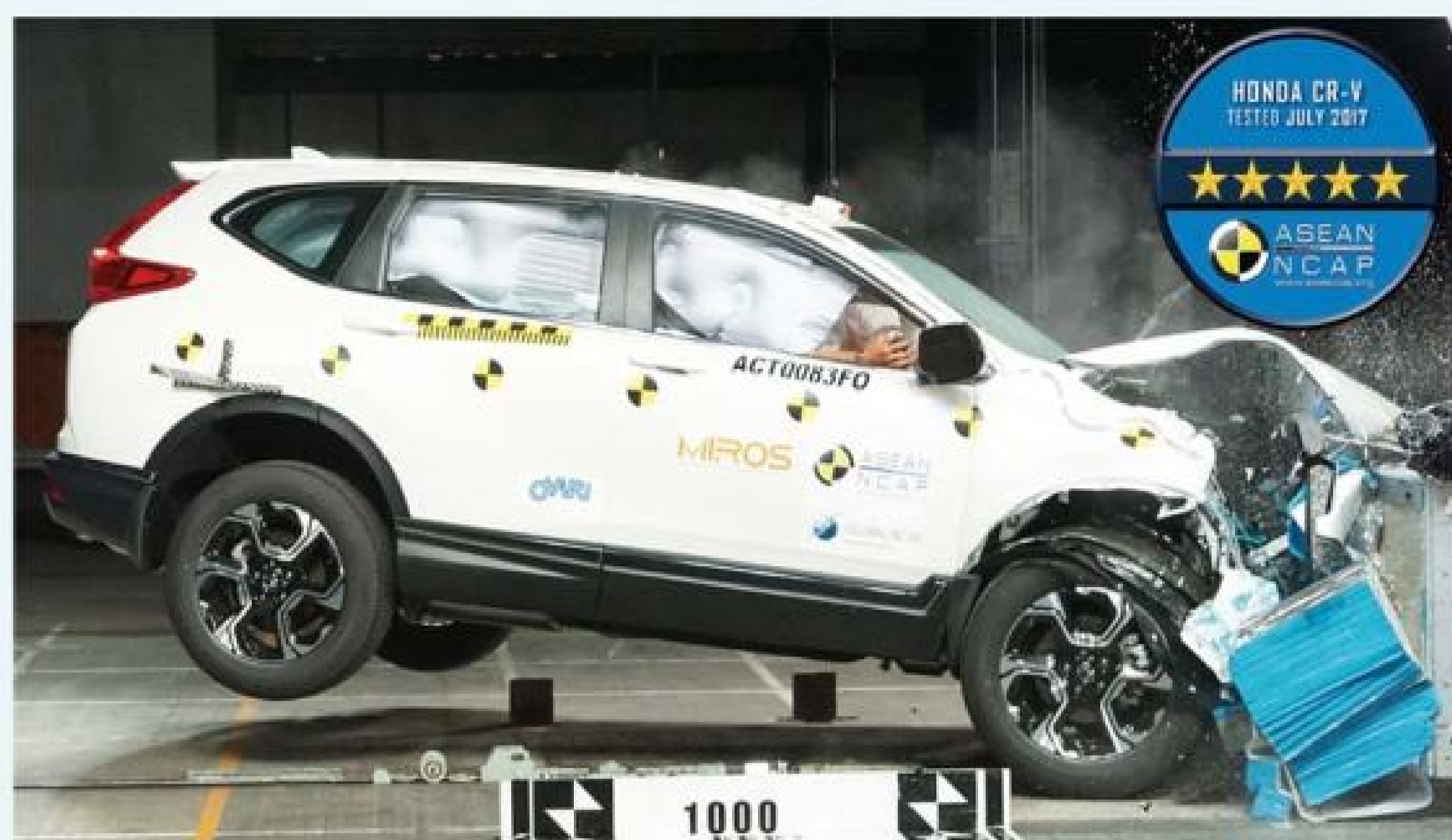
▲於 ASEAN NCAP 撞擊測試獲得五顆星最高評價的全新世代 CR-V，主被動安全考量極其完備。
