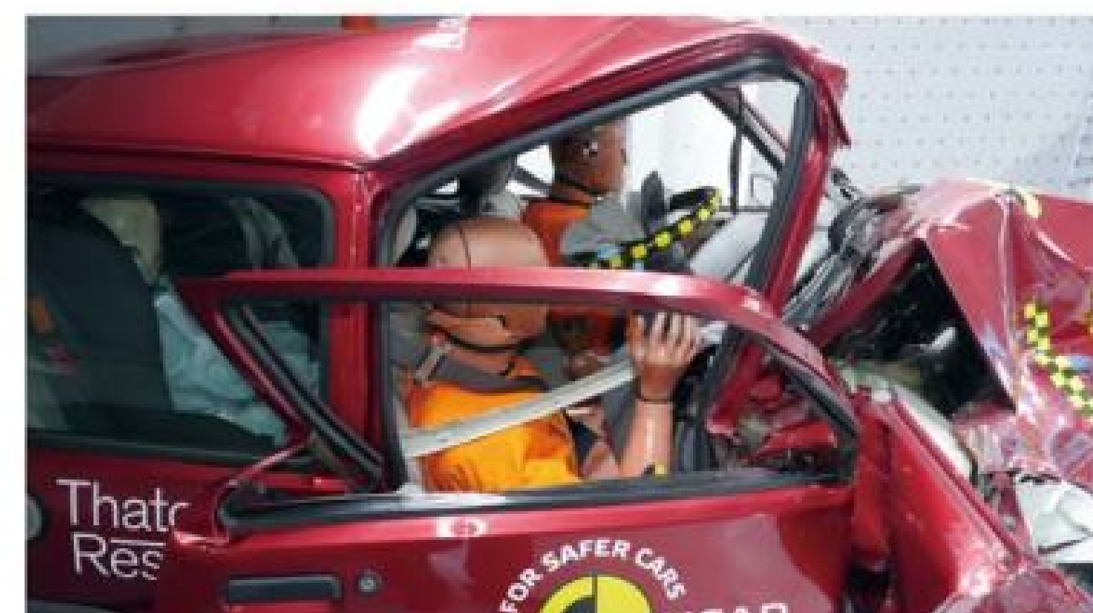
▲ Rover 100 的引擎室已經完全擠壓進車廂，使得人員被困在車內，身體也遭受重傷。
