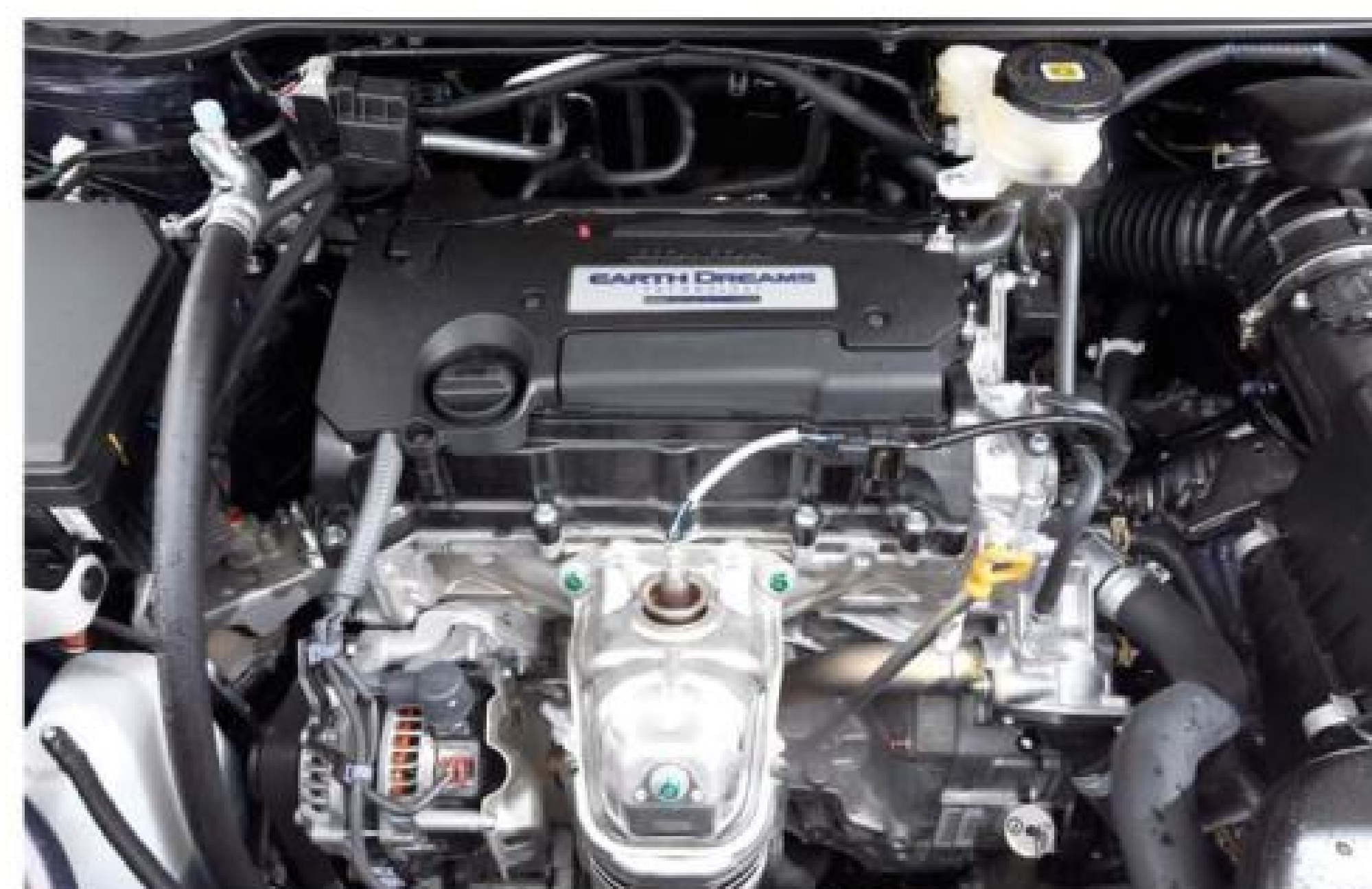
▲搭載 Earth Dreams i-VTEC DOHC 直列 4 汽缸 2.4L 汽油引擎，搭配可模擬 7 速手自排換檔的 CVT 變速箱，可釋出擁有 175 匹、23.0kgm 最大馬力及扭力，平均油耗測試值為 12.9km/L。
