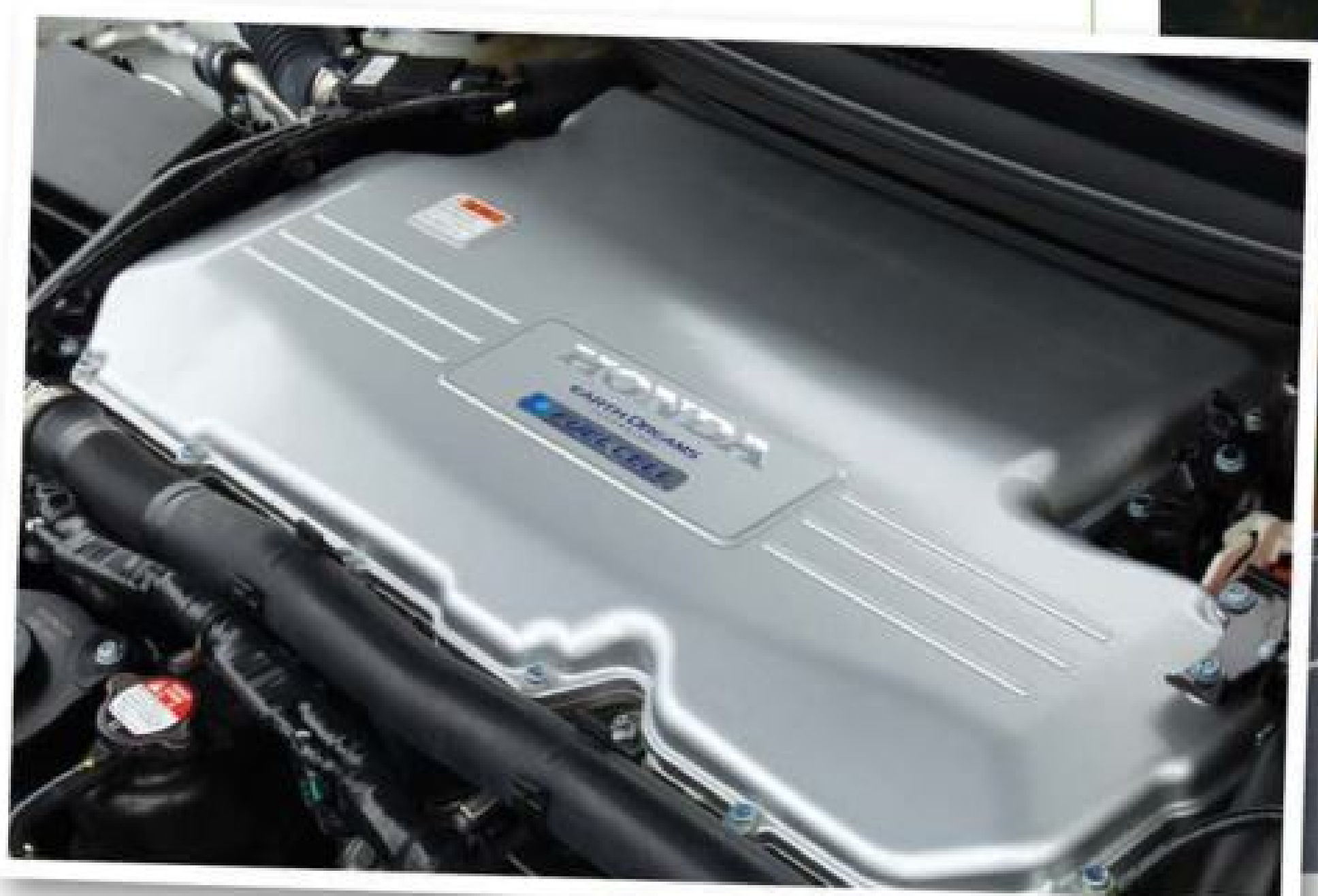
▲ FCV 是用氫氣作為轉換電力的燃料，引擎室內則是高效輸出電動馬達。
