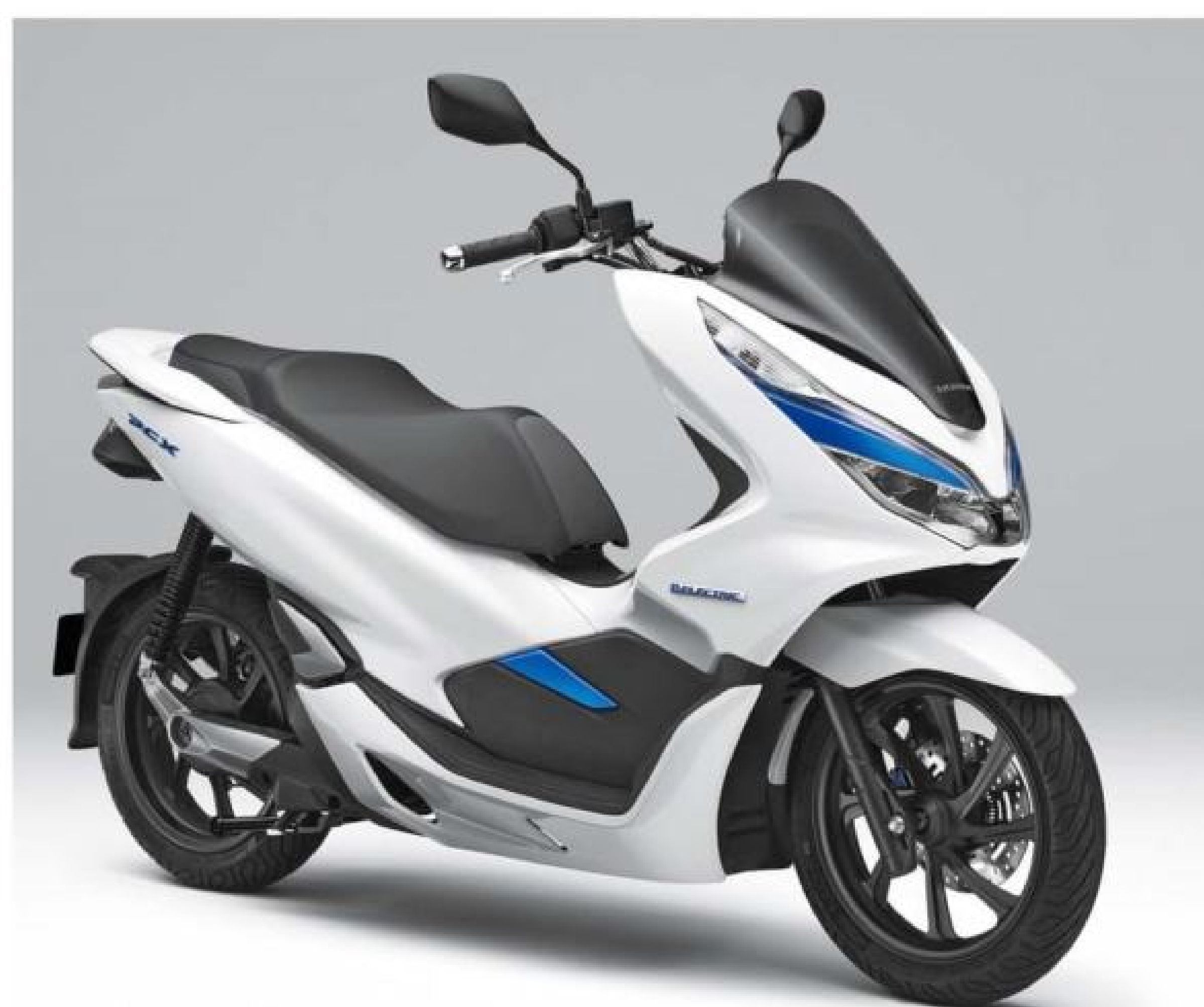
◀ PCX 推出了純電與油電混合兩種版本，其中純電版車型搭載了兩顆可拆卸電池做為能源。
