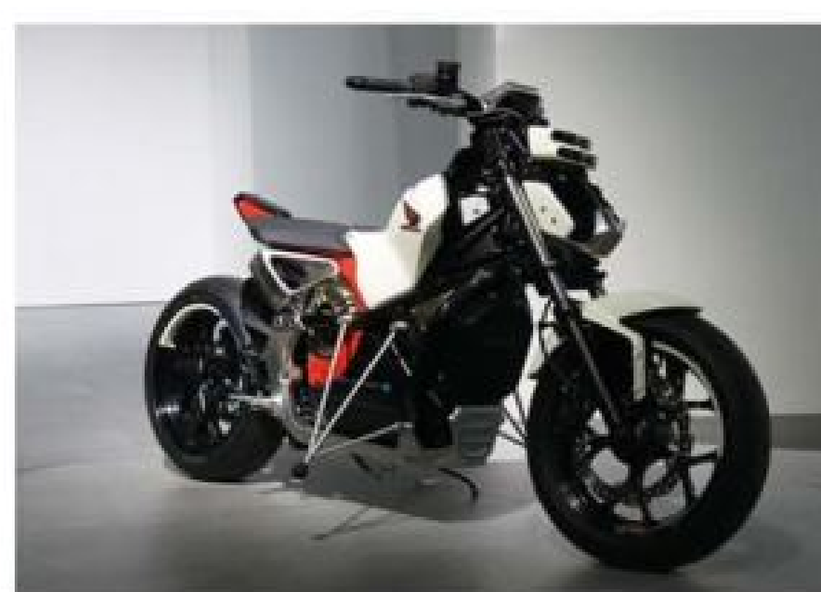
▲ Riding Assist-e 不僅可以自動平衡，也可以跟隨著駕駛者的步行速度自動前行。
