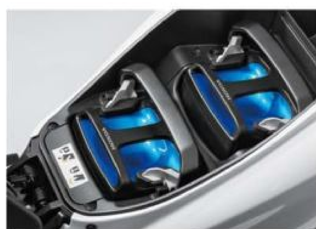
◀ PCX 推出了純電與油電混合兩種版本，其中純電版車型搭載了兩顆可拆卸電池做為能源。
