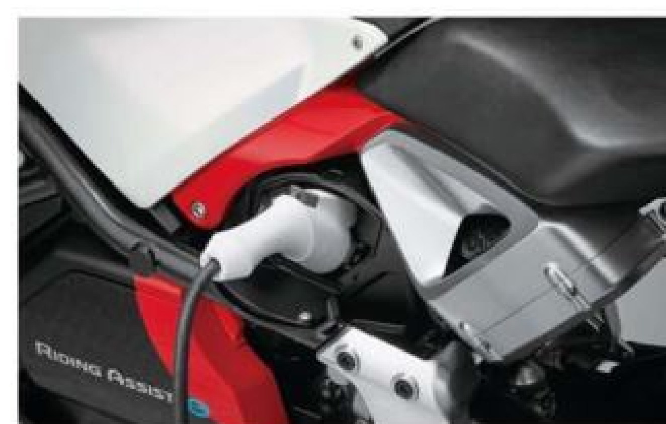
▲ 採用電能作為動力來源，Riding Assist-e 配置了汽車用的充電孔。
