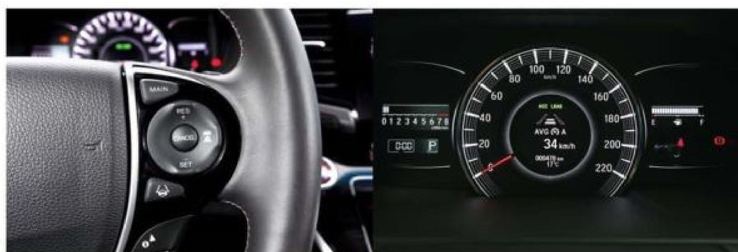
▲ APEX 版本導入搭載 Honda SENSING，方向盤右側新增 ACC 主動式車距調節、定速巡航系統操作鍵，極光行星儀表也增加相關資訊顯示。
