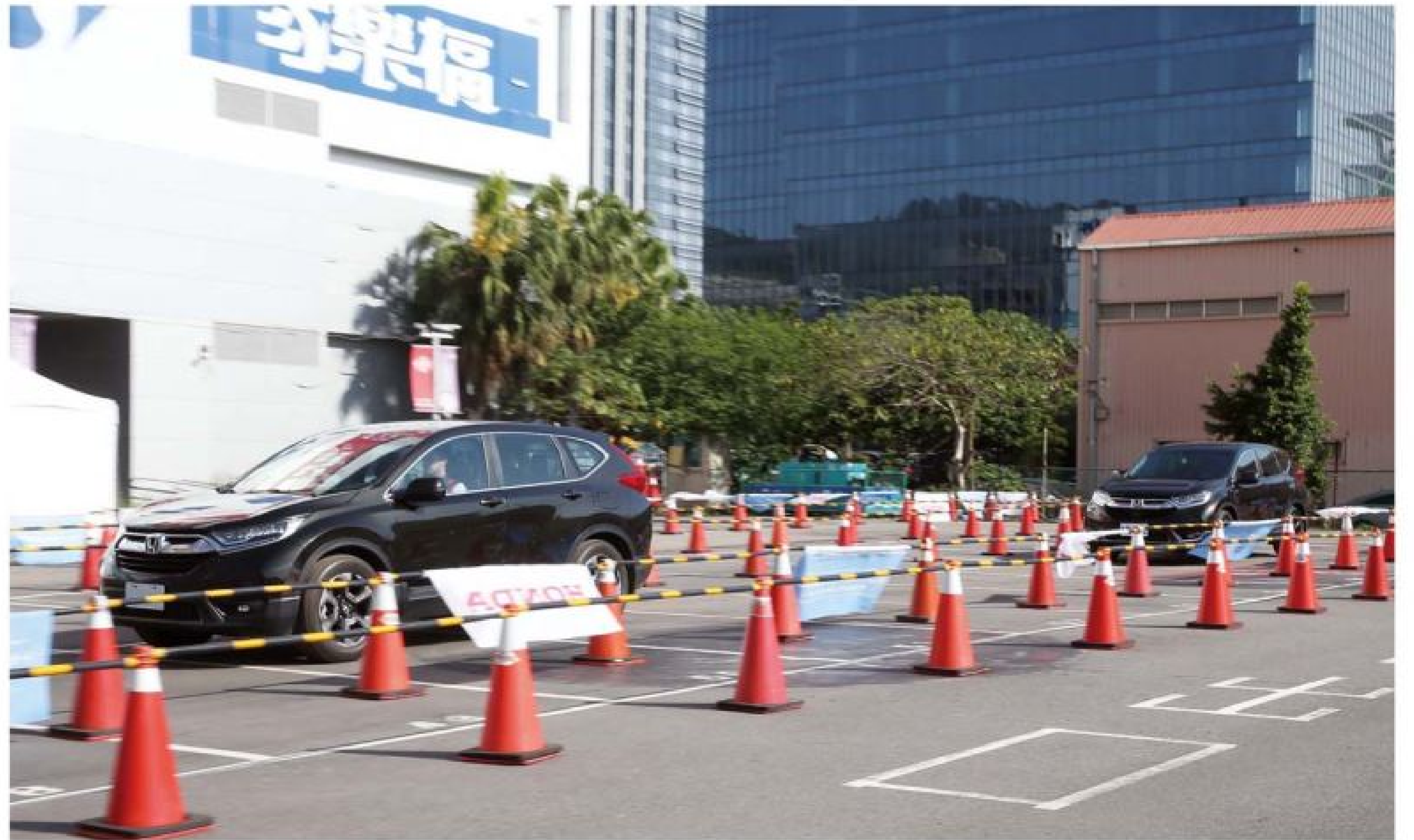
▲在 ACC 系統啟動下，若車速降至 30km 以下（至 0 km/h），則會進入 LSF 低速自動跟車模式，跟隨所偵測鎖定的前方車輛前進、減速及煞停。
