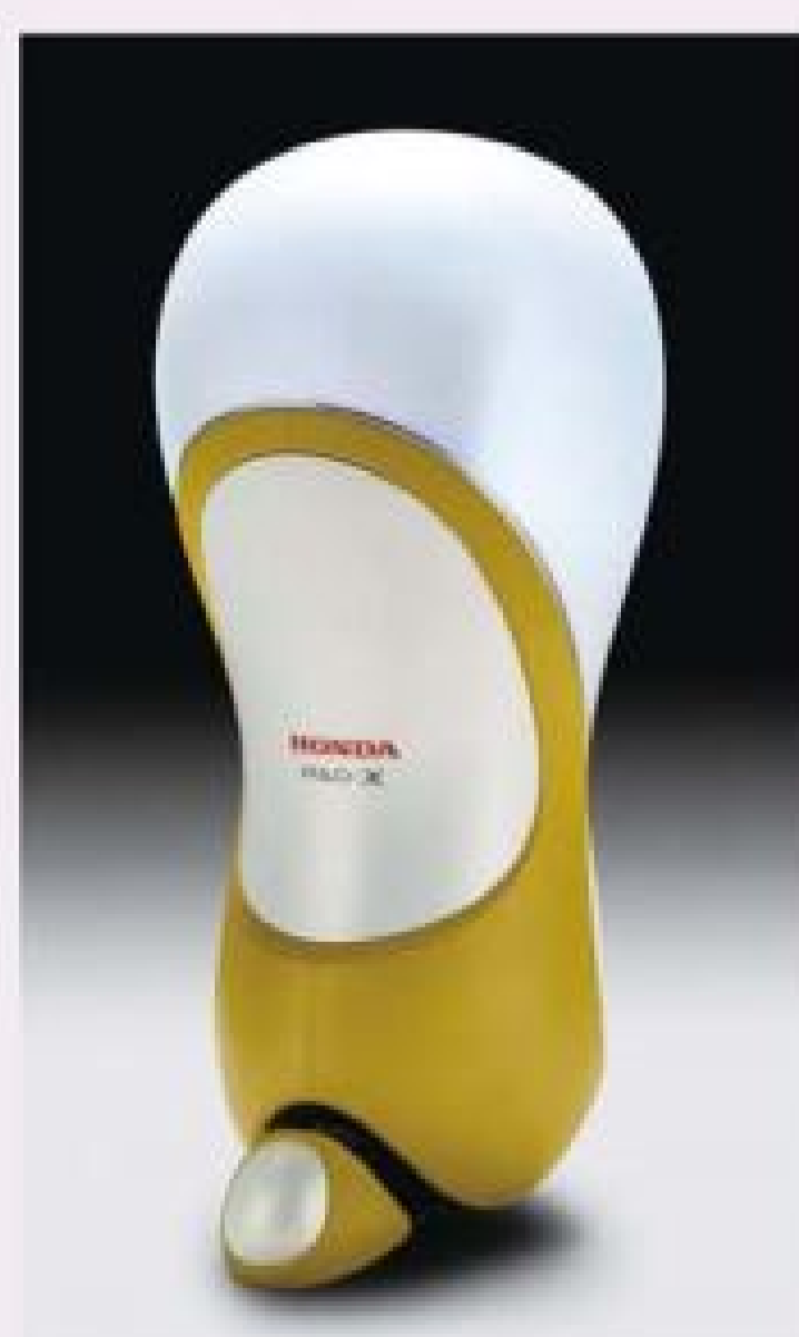
◀ 採用 Honda 獨家的全方位單輪機構，3E-A18 能朝任何方向自由移動。
