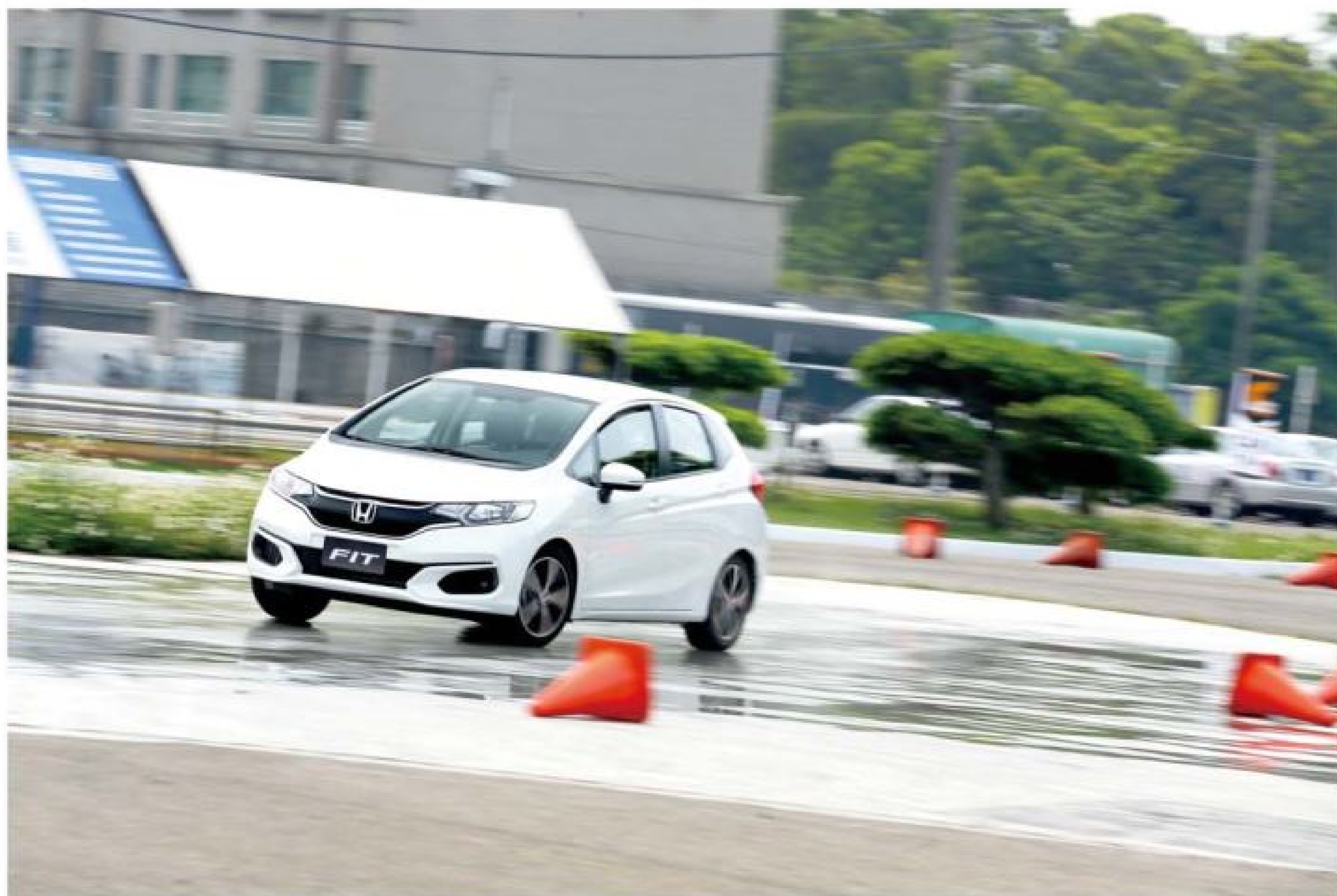
◀ 關卡之一的濕滑路面，可令評審更加了解候選車於抓地力不足時的動態反應，以及主動安全系統的作動效率。
