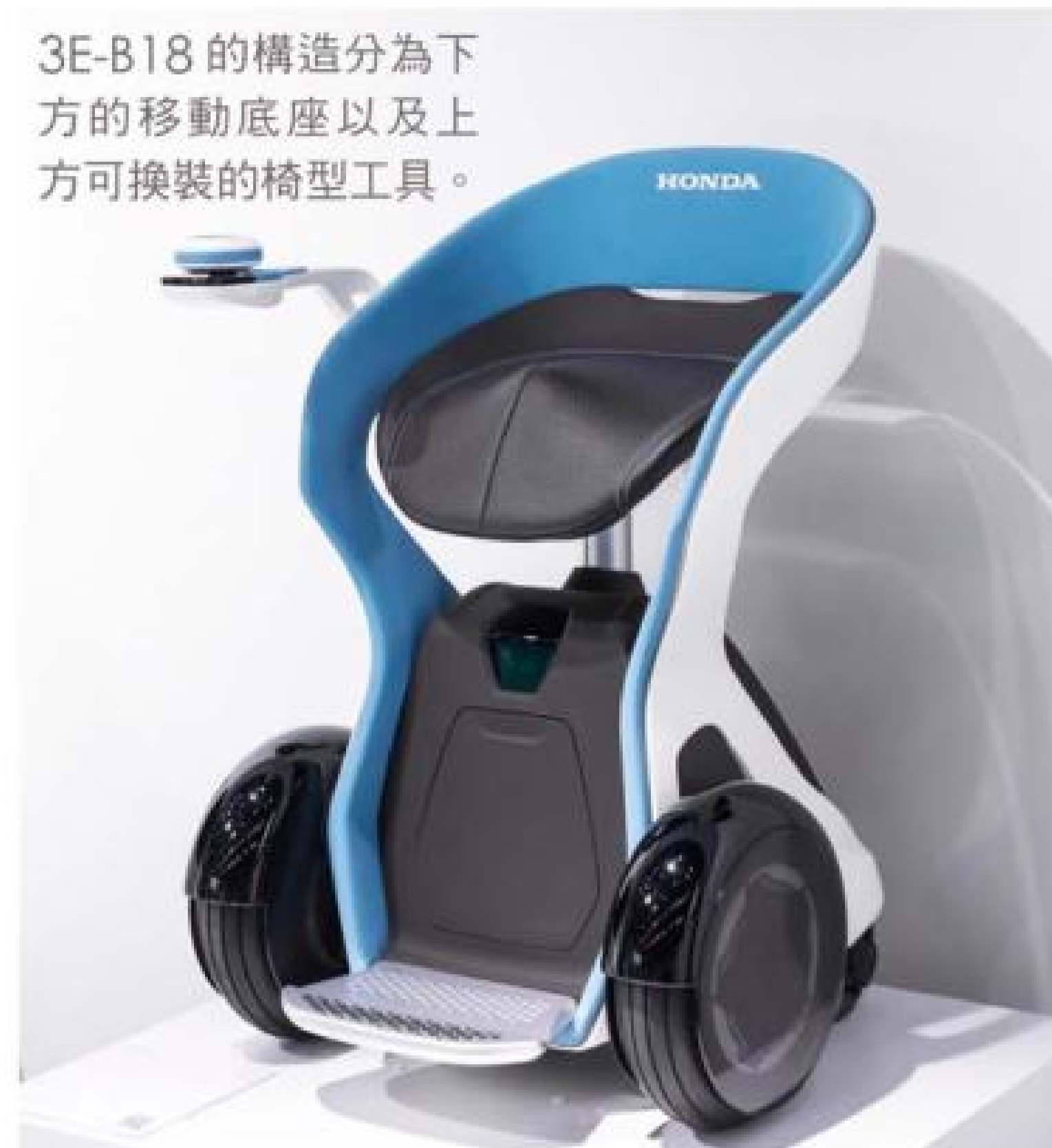
▲ 3E-B18 的核心為平台底座，上方換裝即可更換不同用途。
