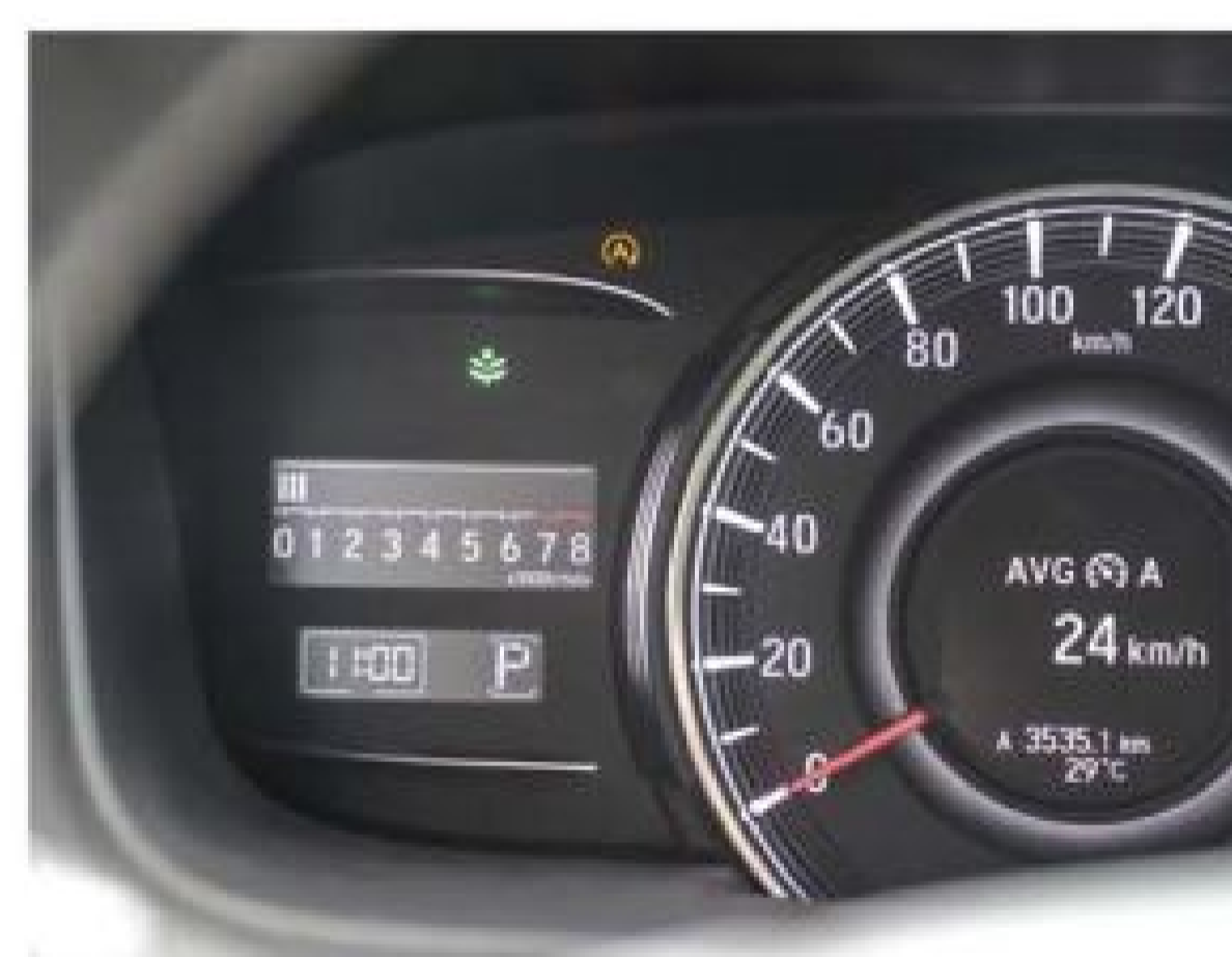
▲當車輛暫時停止時，Idle Stop 怠速節能系統會適時控制引擎熄火節省燃油。
