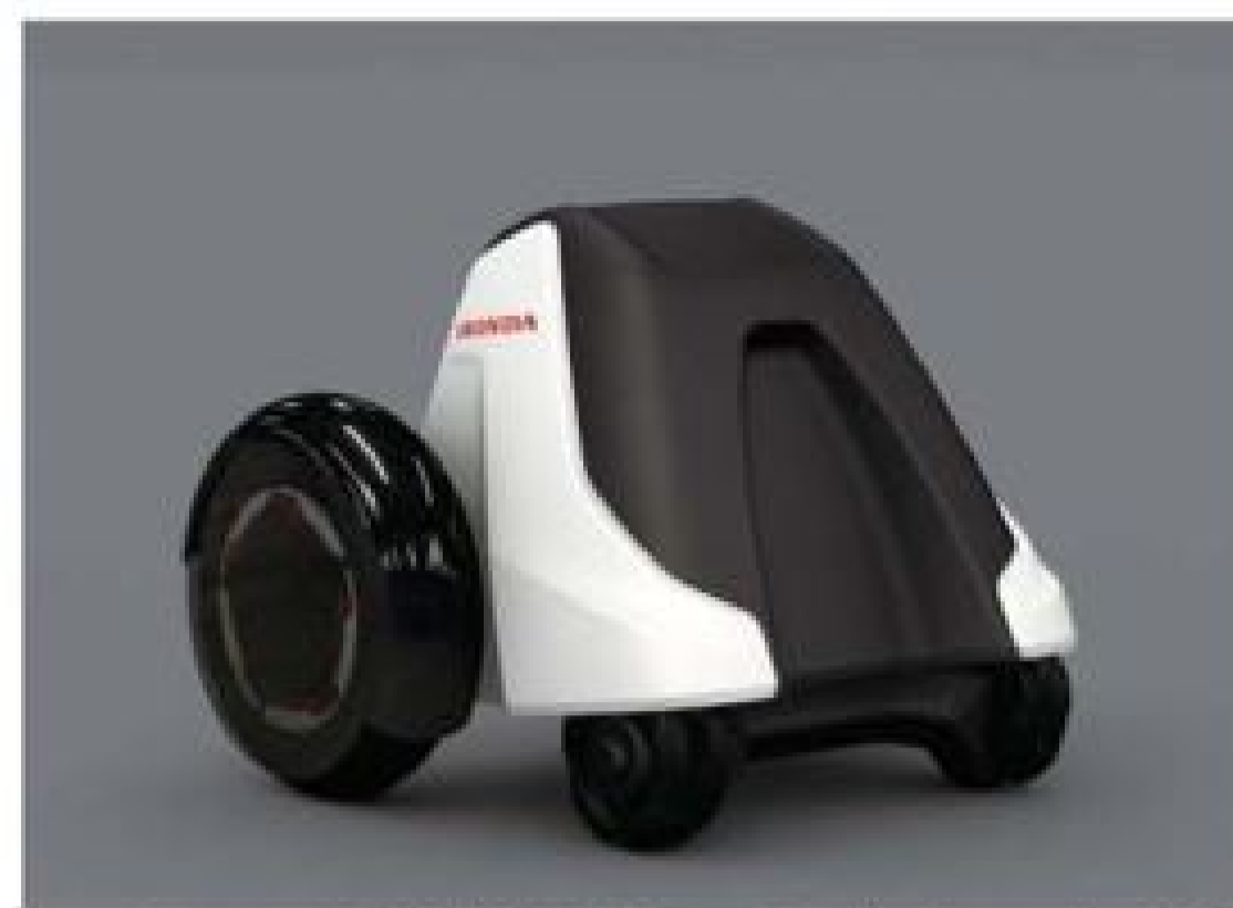
▲ 3E-B18 的核心為平台底座，上方換裝即可更換不同用途。
