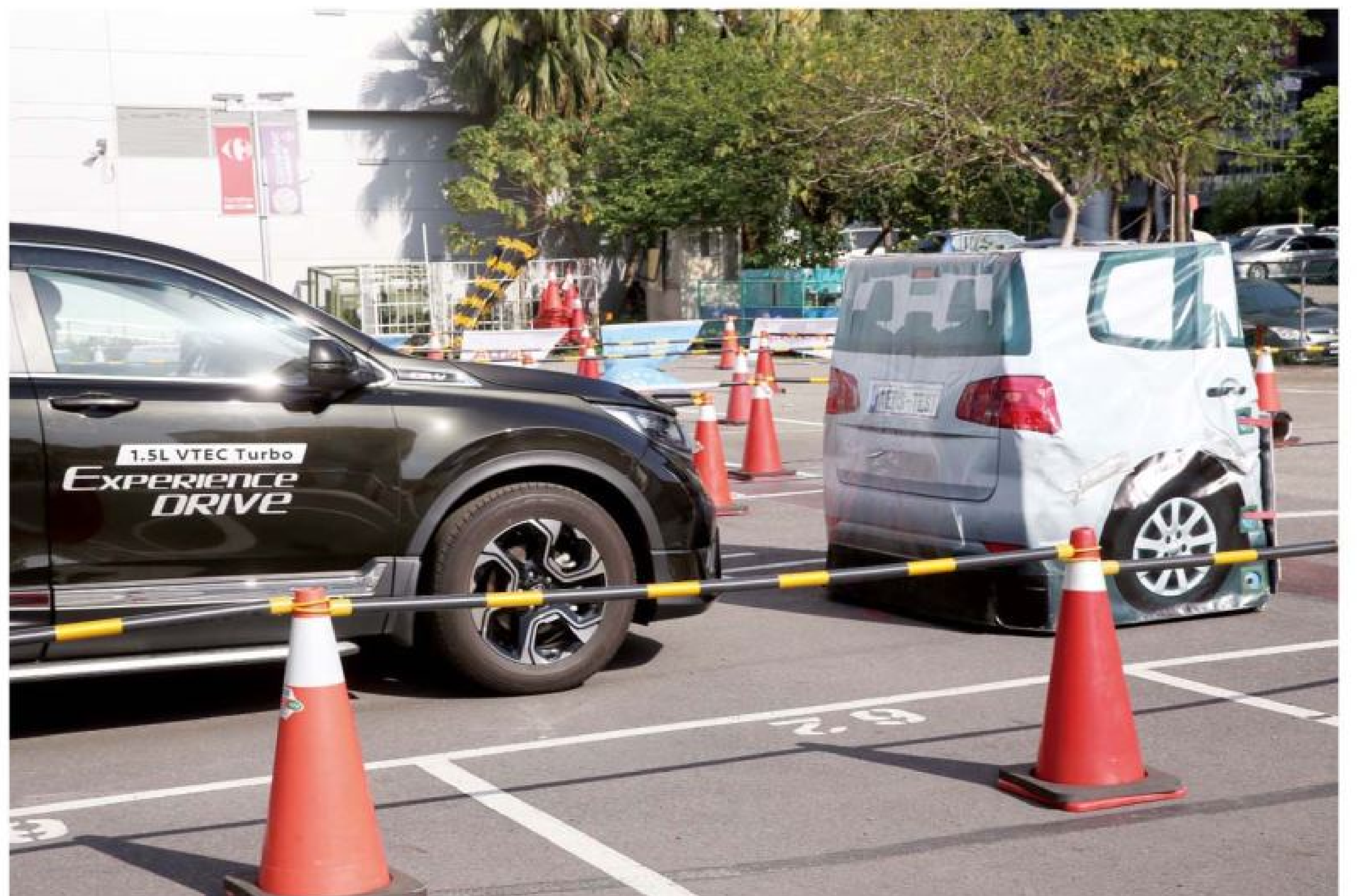
▲CMBS 碰撞緩解煞車系統是在車輛將發生撞擊風險時，除會預縮緊束安全帶之外，更會主動煞停來避免撞擊事故發生。
