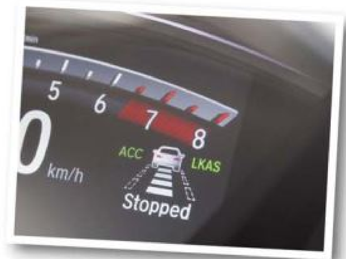
▲在 LSF 低速自動跟車系統作動下，若車輛靜止時則會顯示 Stopped，且停止時間若超過 5 秒鐘系統即會自動解除，待前方車輛繼續前進時，只要再按下 RES 鍵就會回復功能繼續跟車。
