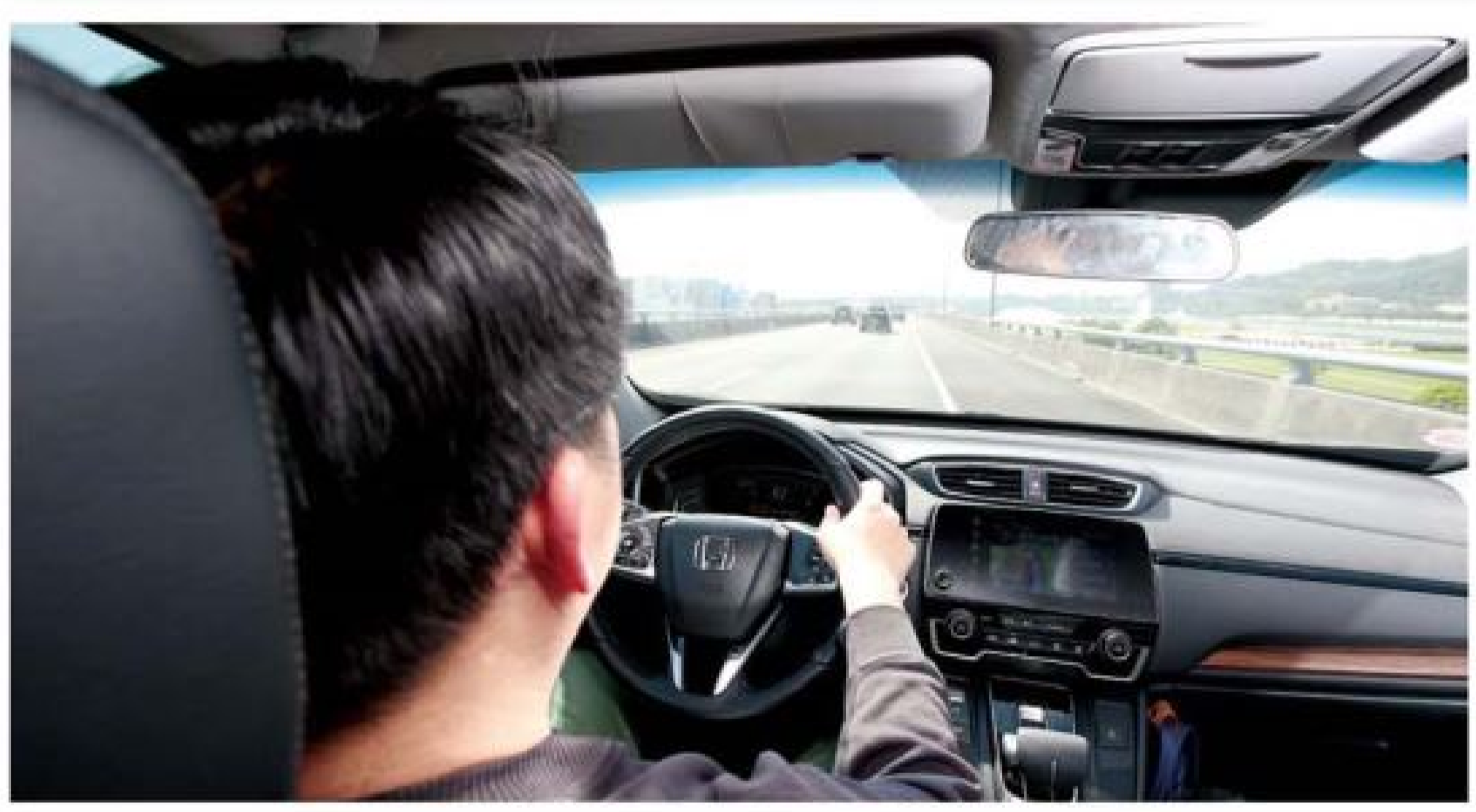
▲在刻意將車輛往右偏向道路邊界線時，LDW/LKAS 系統即會開始作動，以振動方向盤及在儀錶出現警告圖示的方式來提醒駕人注意，同時也會自動提供轉向輔助力道以修正行車動線，讓車輛維持行駛在車道內。
