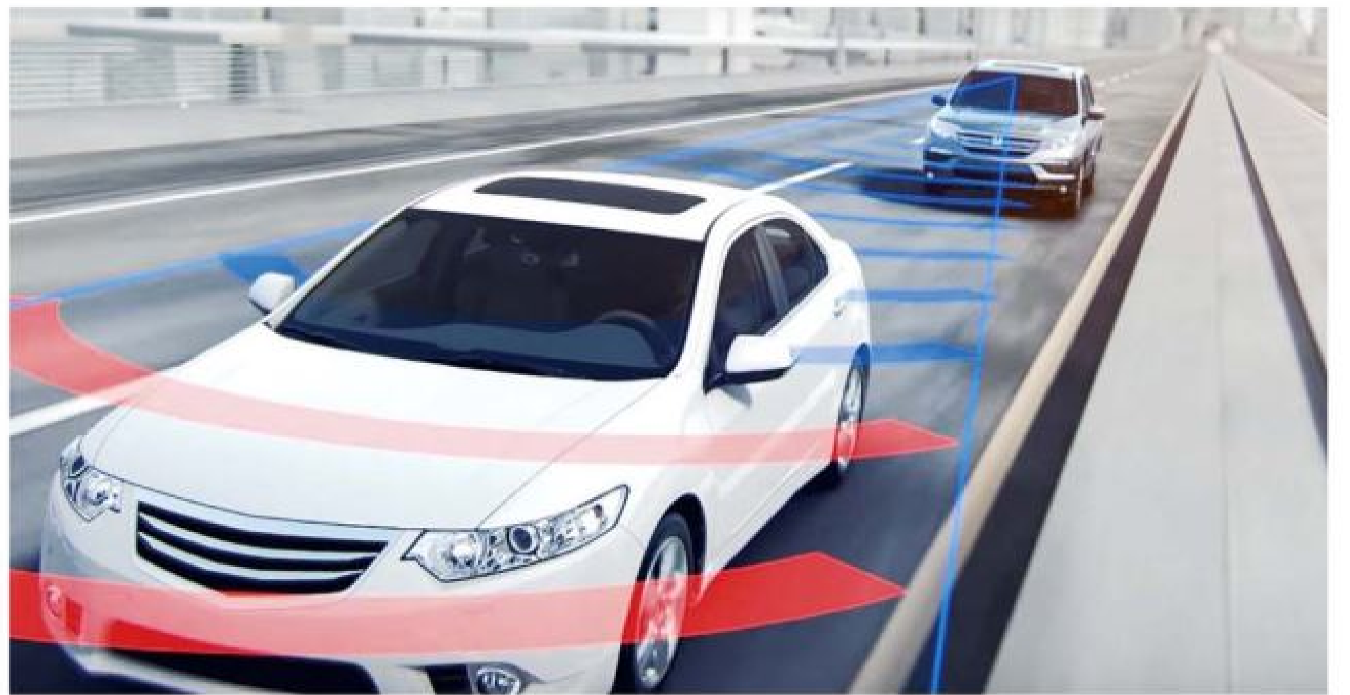
▲CMBS 碰撞緩解煞車系統是透過車頭的毫米雷達掃描以及搭配攝影機圖像辨識功能來啟動系統，但並非所有圖像都能辨識而讓系統作動，需具有汽車特徵的圖像才行。
