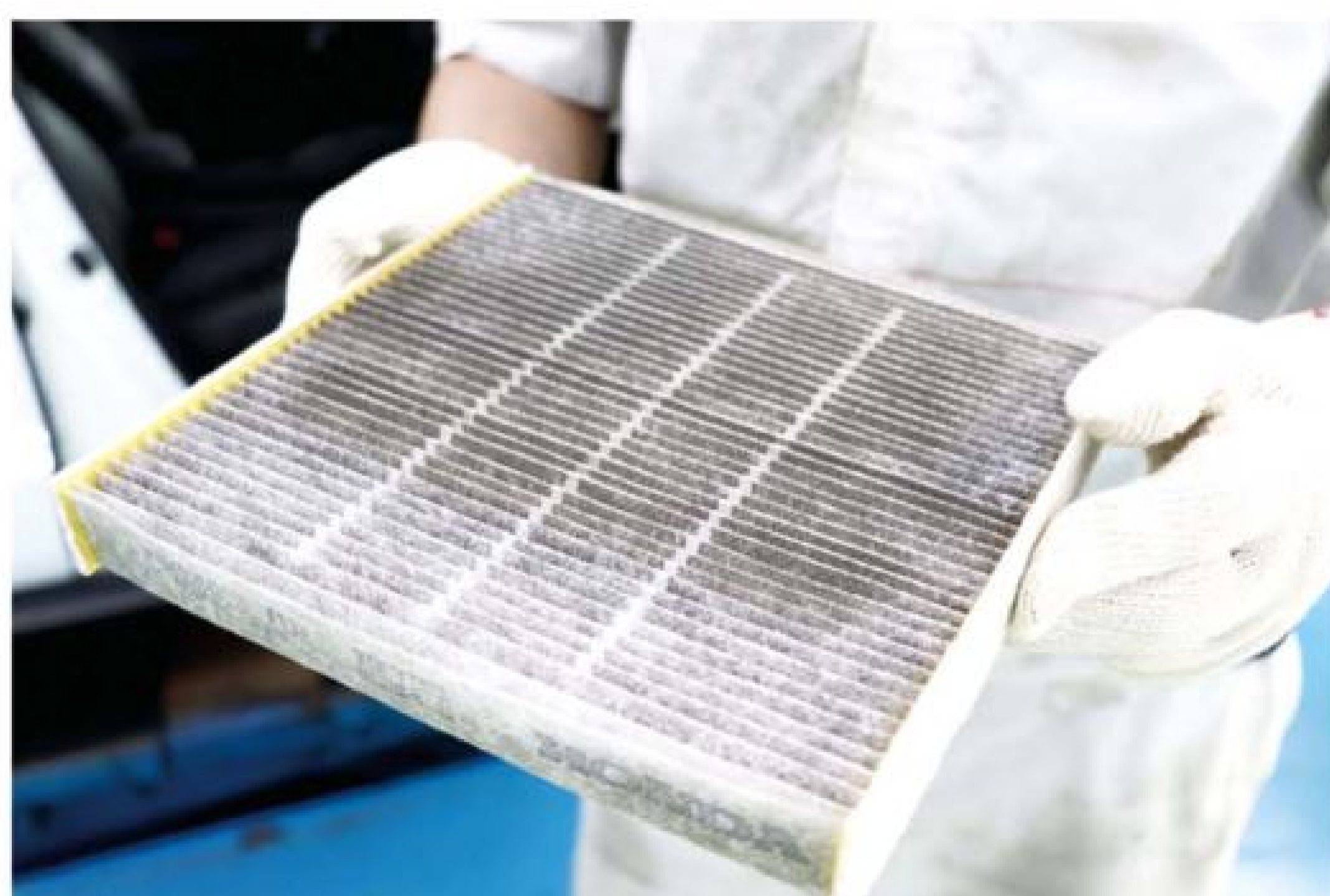
▲當前空氣污染嚴重，使用了 1 萬公里後的原廠空氣濾網就有可能嚴重髒污需要更換。
