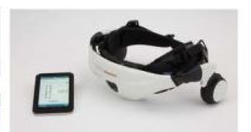
▲ Honda 步行輔助設備配戴於下半身，並能以行動裝置進行設定。
