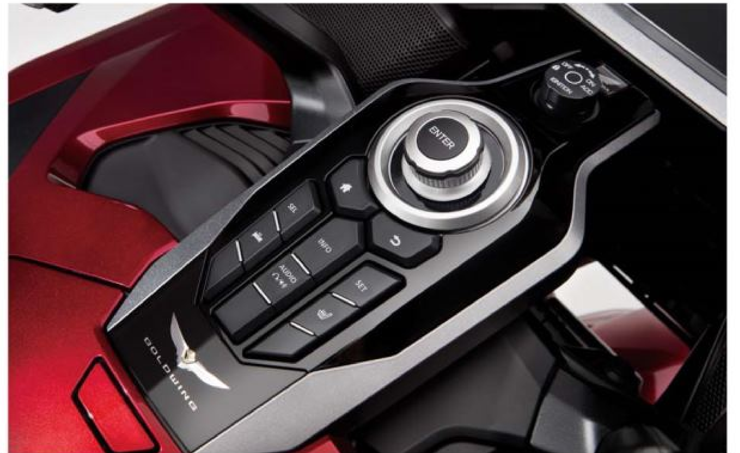
▲龍頭鎖後操控面板不僅可用來操控螢幕顯示功能，也可同時控制音響系統。
