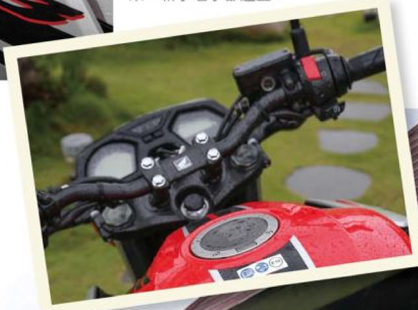
▼符合人體工學의平把設計，加上極具科技感與易於辨識的分離式液晶資訊儀表，CB650F 相當易於騎乘，新手老手都適宜。
