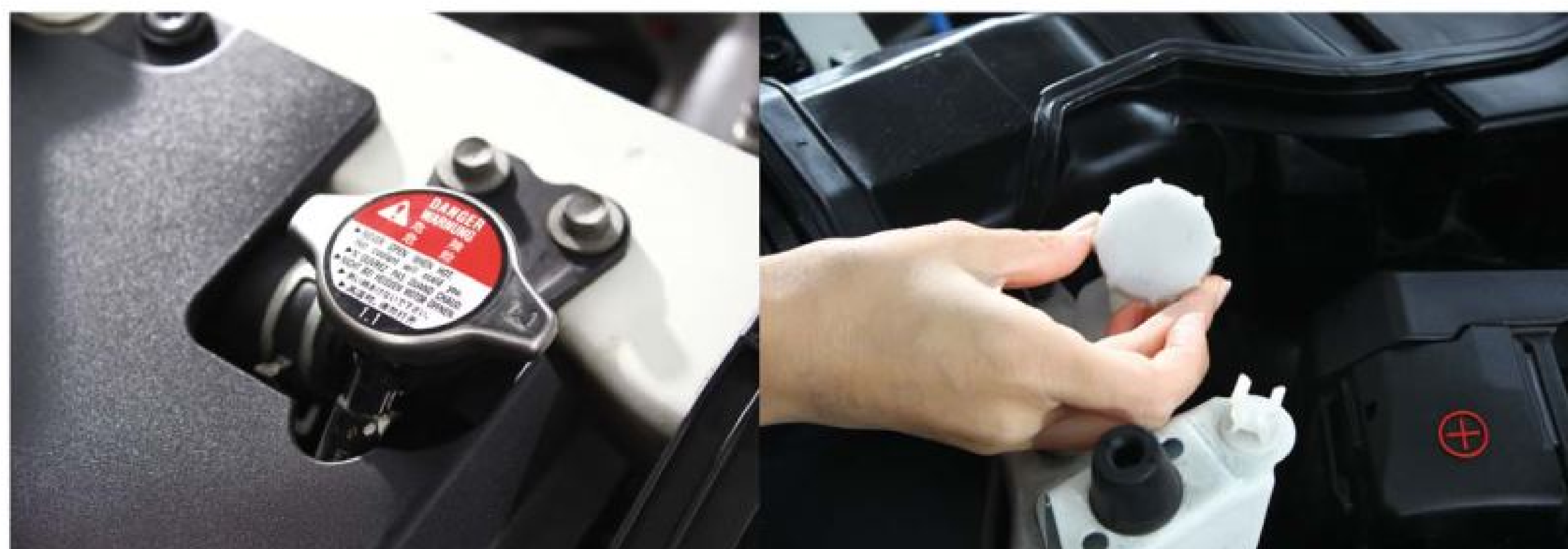
肩負動力系統冷卻任務的水箱相當重要，須定期檢查主、副水箱水位是否正常（切記冷車時方可開啟水箱蓋）。
