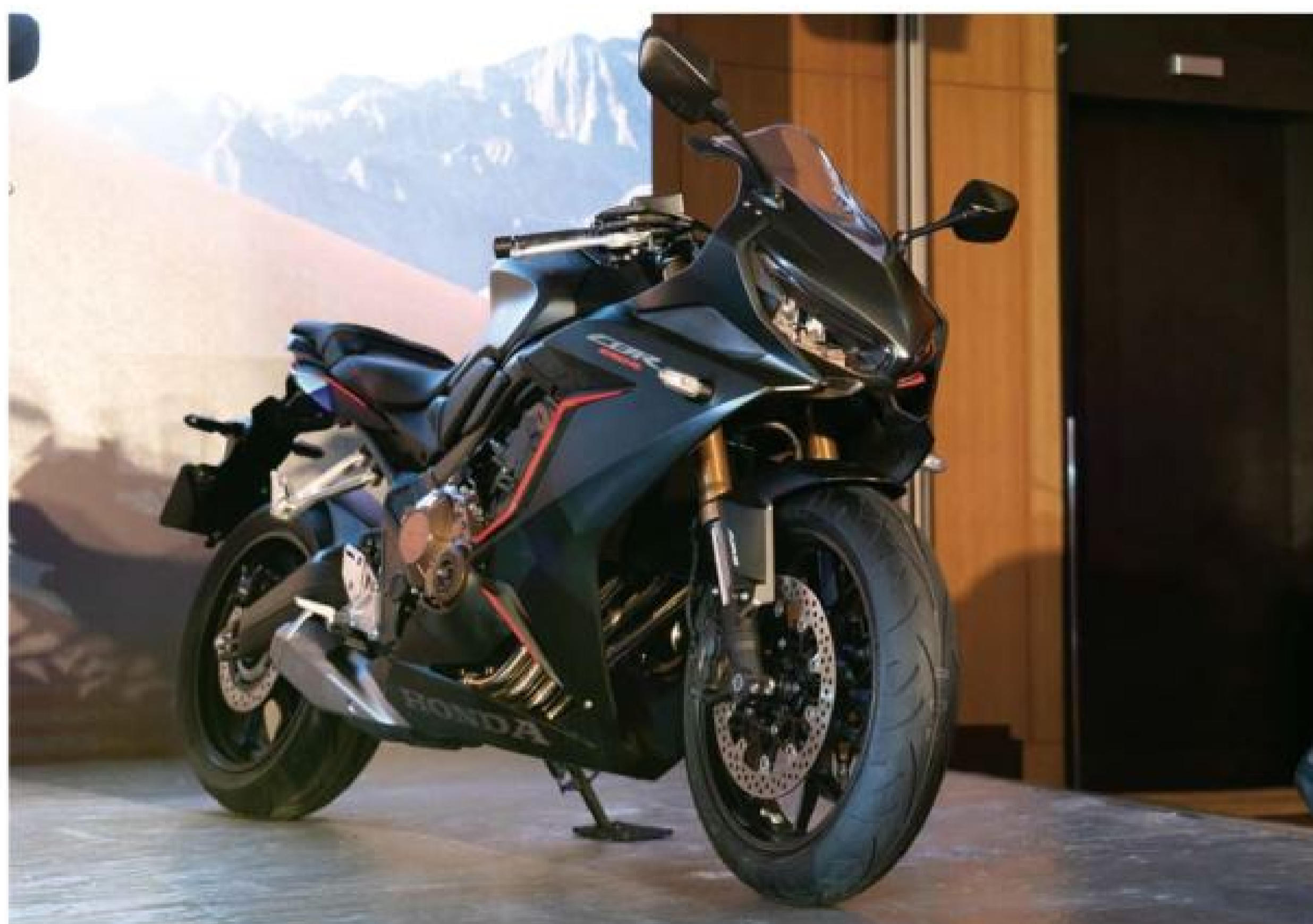
2019 年式 CBR650R 換上雙燈造型，再加上 41mm Showa SFF 倒立前叉、滑動式離合器、扭力控制系統等好料全數上身，運動性能更上層樓。
