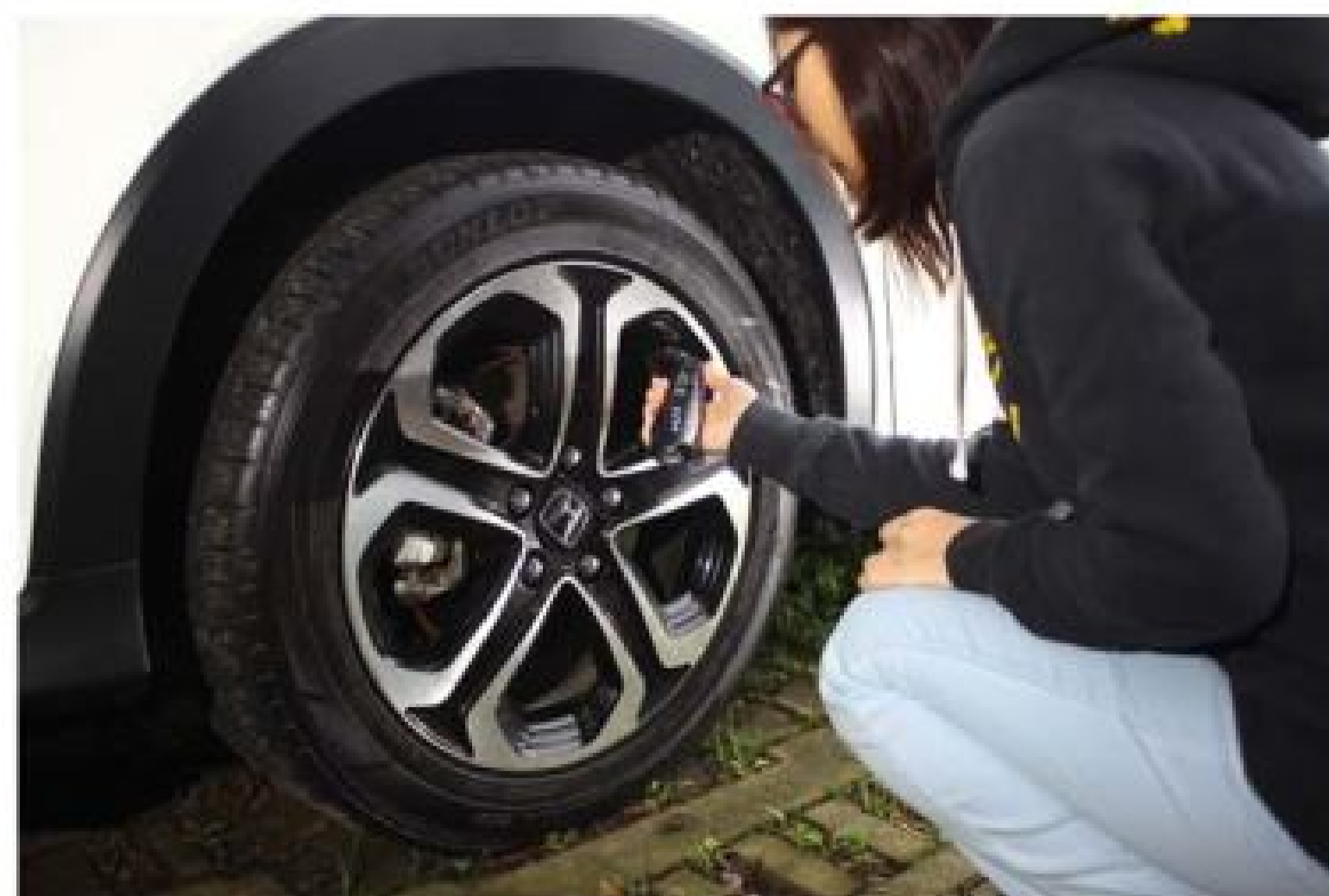
除胎紋深度以及輪胎狀況需檢查外，未裝置 TPMS 胎壓偵測系統車輛需定期以胎壓計量測之。
