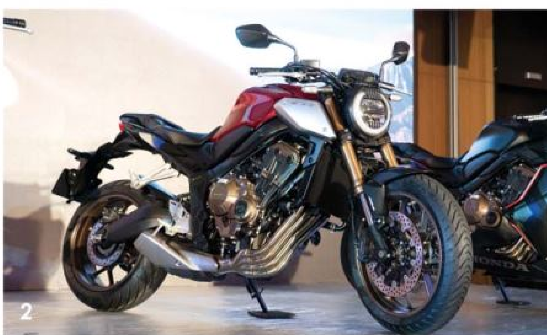
2019 年式 CBR650R 換上雙燈造型，再加上 41mm Showa SFF 倒立前叉、滑動式離合器、扭力控制系統等好料全數上身，運動性能更上層樓。
