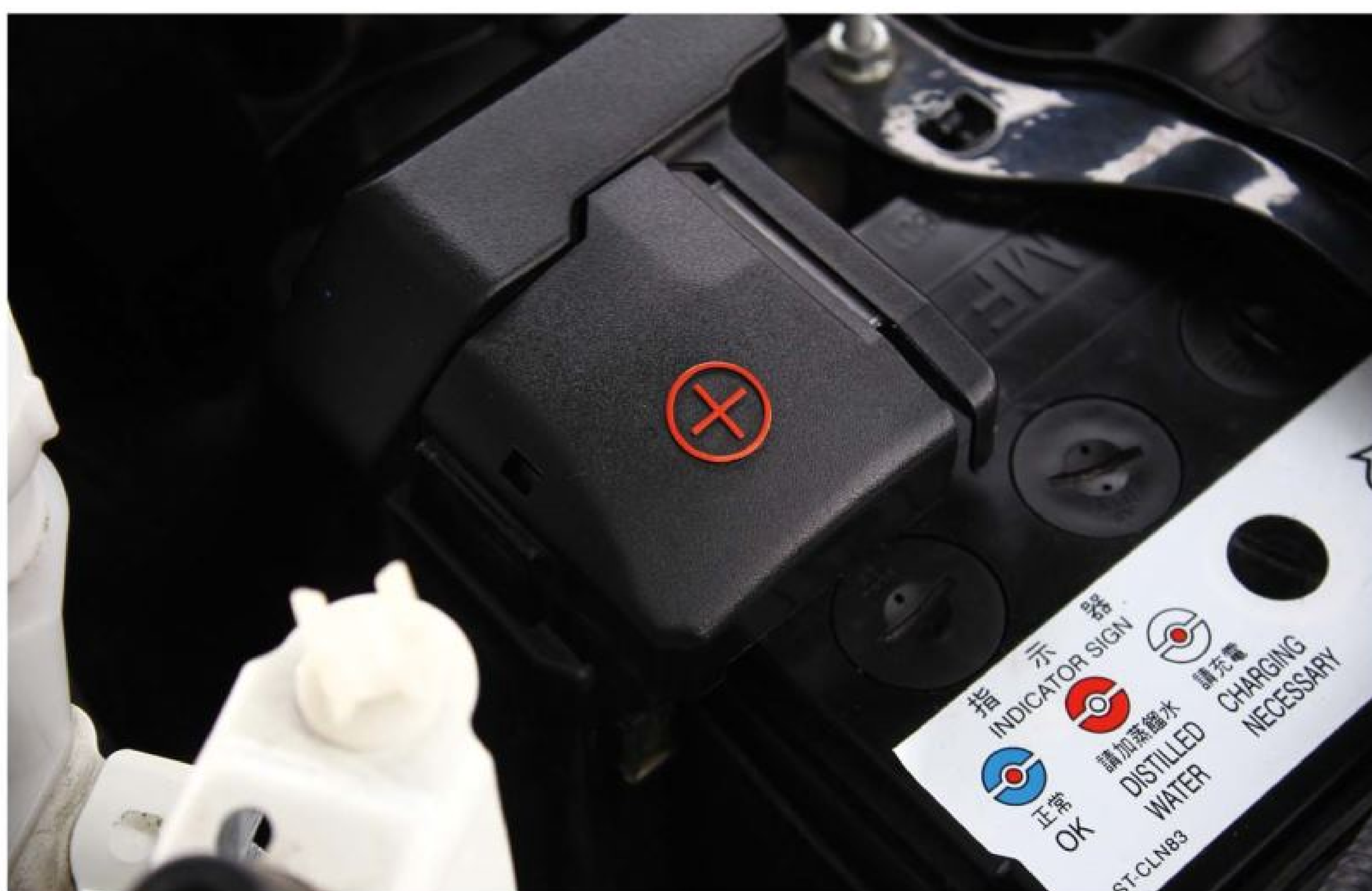
加水電瓶可透過指示器觀察水位，免加水電瓶則請至 Honda Cars 進行檢測。
