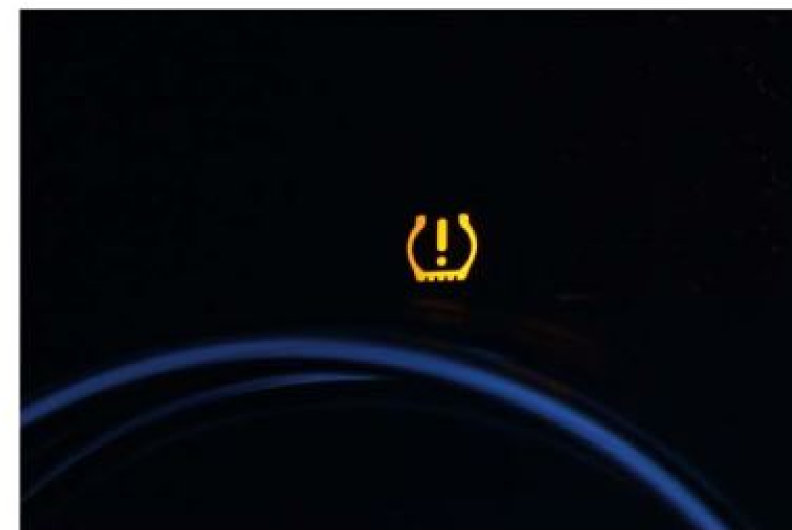
備有 TPMS 胎壓偵測系統的新款車型，當胎壓異常時將會在儀錶出現此一燈號，若亮起請儘速檢查並處置。
