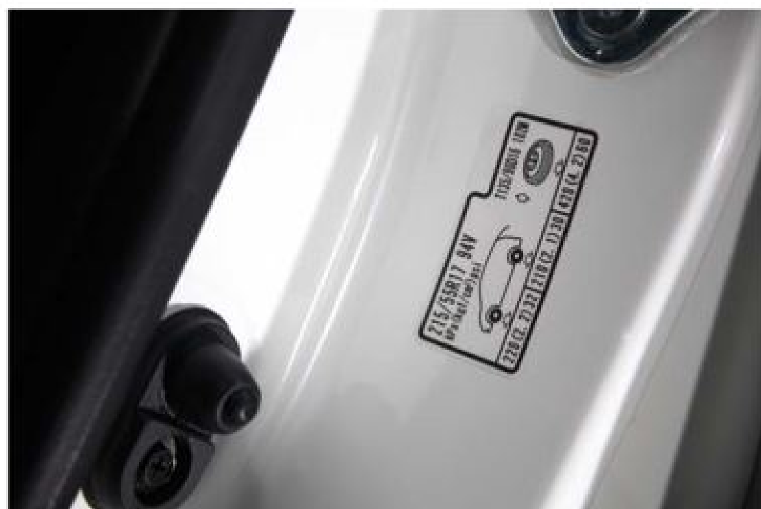
胎壓標示通常位於駕駛座側 B 柱上，須開啟車門方能看見。
