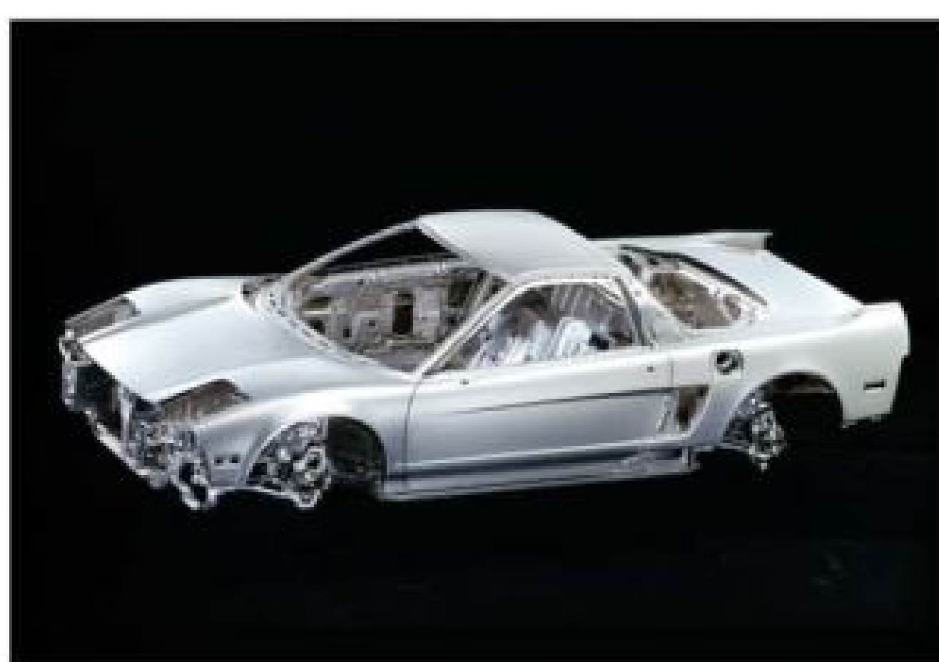
▲ 第一代 NSX 是全世界第一款採用全鋁合金材質單體車身的手工量產車，車架本身總重只有 210 公斤。
