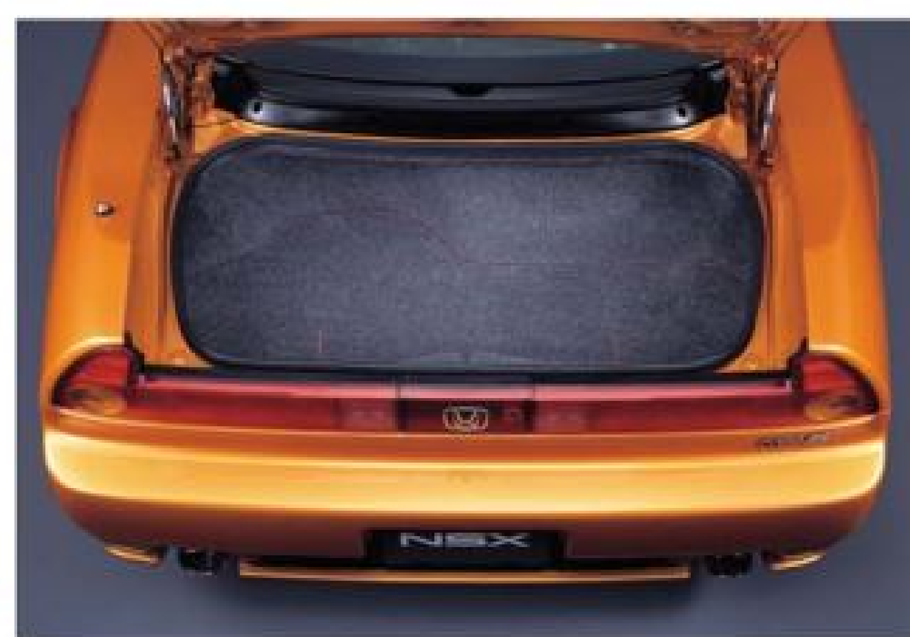
▲ 第一代 NSX 採用中橫置引擎佈局，使得引擎室後方還有行李廂空間，比歐系超跑更加實用。
