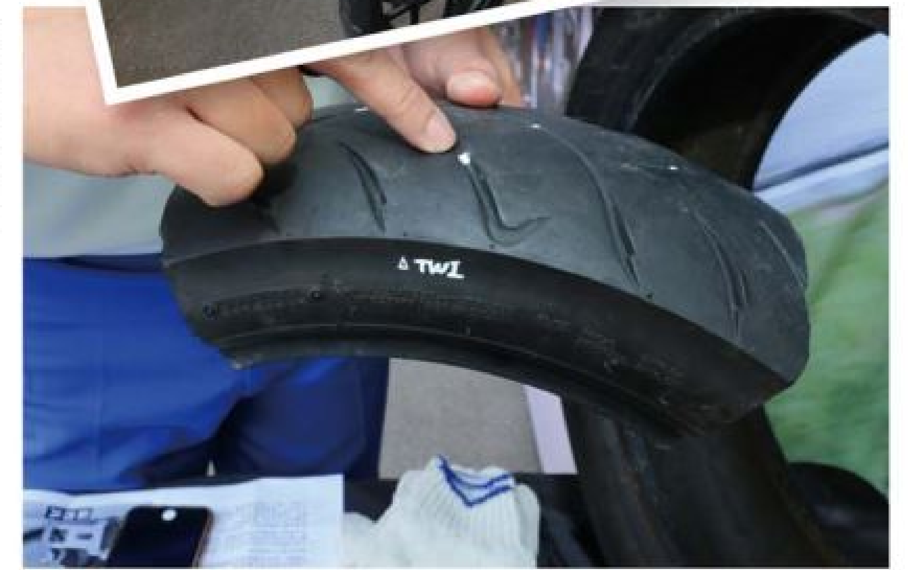
►輪胎磨損的安全性，由輪胎側邊的三角去對照輪胎上的凹痕，若已磨到指示位置，車主就該更換新輪胎才安全。
