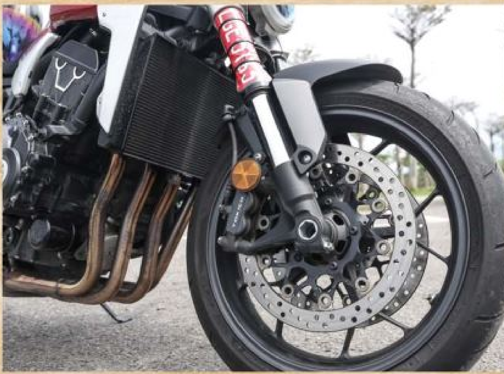
▲CB1000R 搭載源自當家跑車 CBR1000RR 的直列四缸引擎，998c.c. 排氣量中具備 87hp/9kgm 的強悍輸出。
