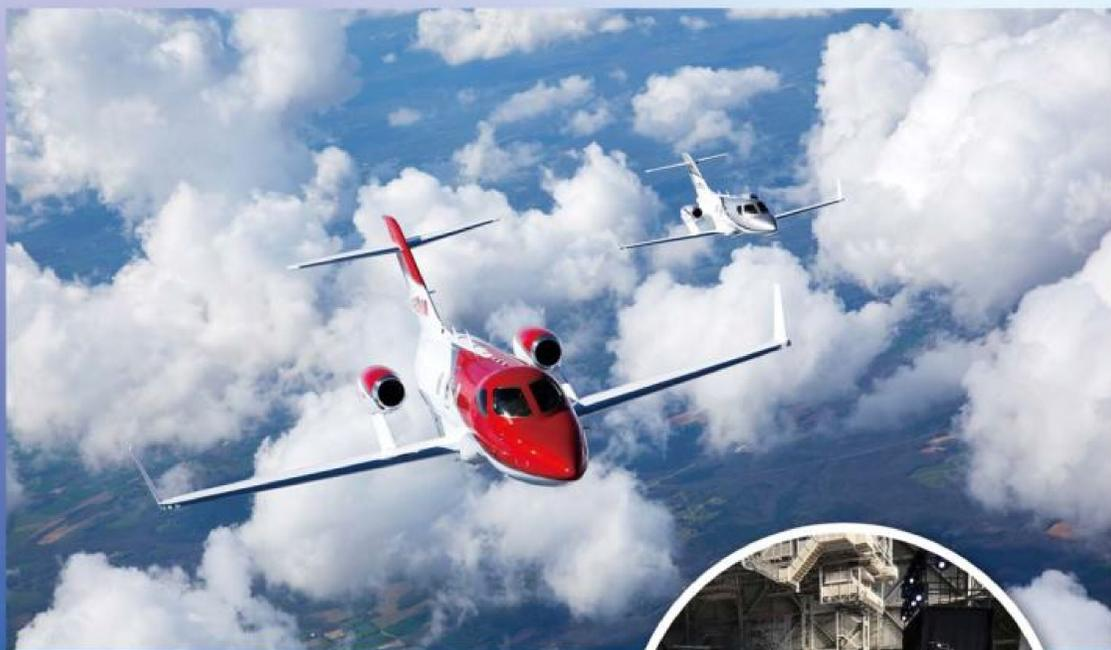
HondaJet 外部長度及高度為 12.99 及 4.54 公尺，內含油箱的主翼寬 12.12 公尺，引擎設置於主翼上方為性能及舒適帶來許多優勢。
