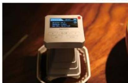
◀精密的烘焙度電子儀器可以做烘焙程度的確認。
