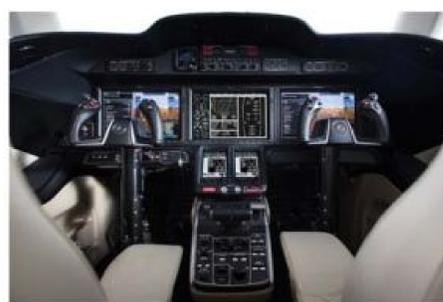
HondaJet 的駕駛儀錶採用 Garmin 專屬開發的 G3000 次世代全玻璃飛行系統，設計造型美觀並富有功能性。
