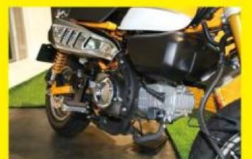
Monkey125 搭載 125c.c. 單缸氣冷四行程單缸，結合 PGM-FI 電子燃油噴射科技，具備 9.2hp/7000rpm 最大馬力與 1.1kgm/5250rpm 最大扭力輸出表現。
