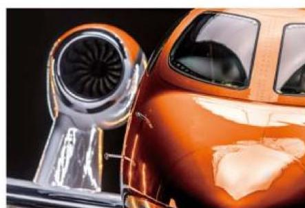
位於 HondaJet 機首右側的常用及備用皮托測風管，藉由風壓感應，可精密測量飛行速度。
