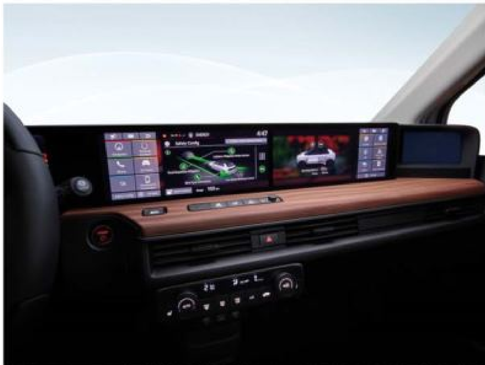
兩具 12.3 吋多功能觸控螢幕可獨立操作不同的功能或系統，甚至可將程式彼此拖曳排列。
