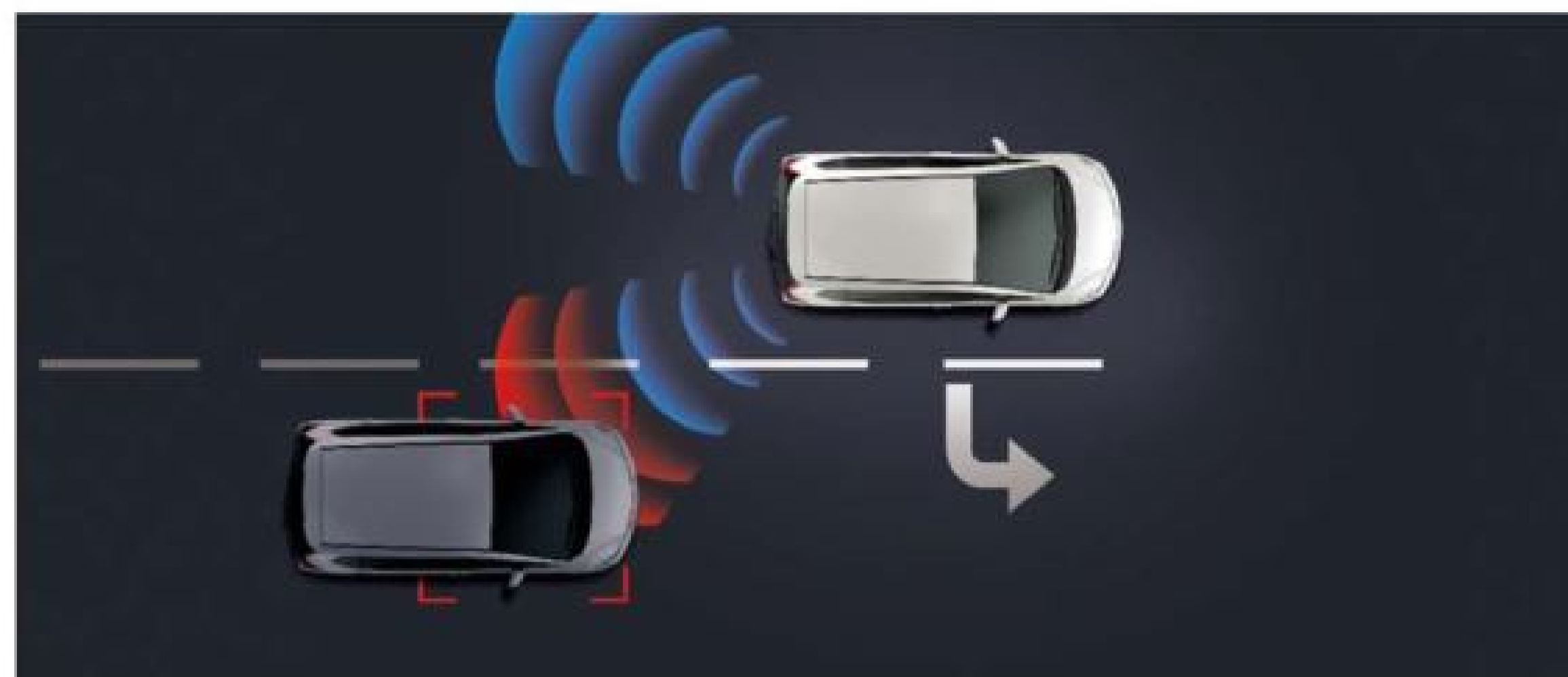
LCA 變換車道警示可於換道時監測後方有無來車並加以提示。
