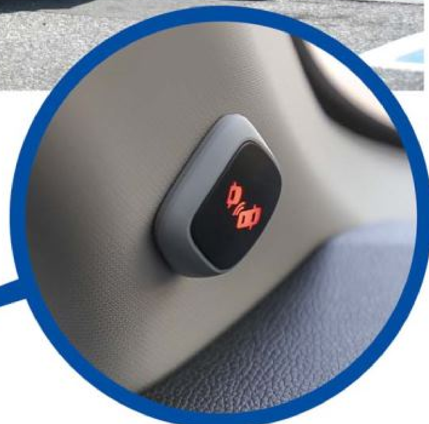
六合一盲區智慧語音防護系統具備語音提示功能，能夠以人聲方式提醒駕駛者注意。
