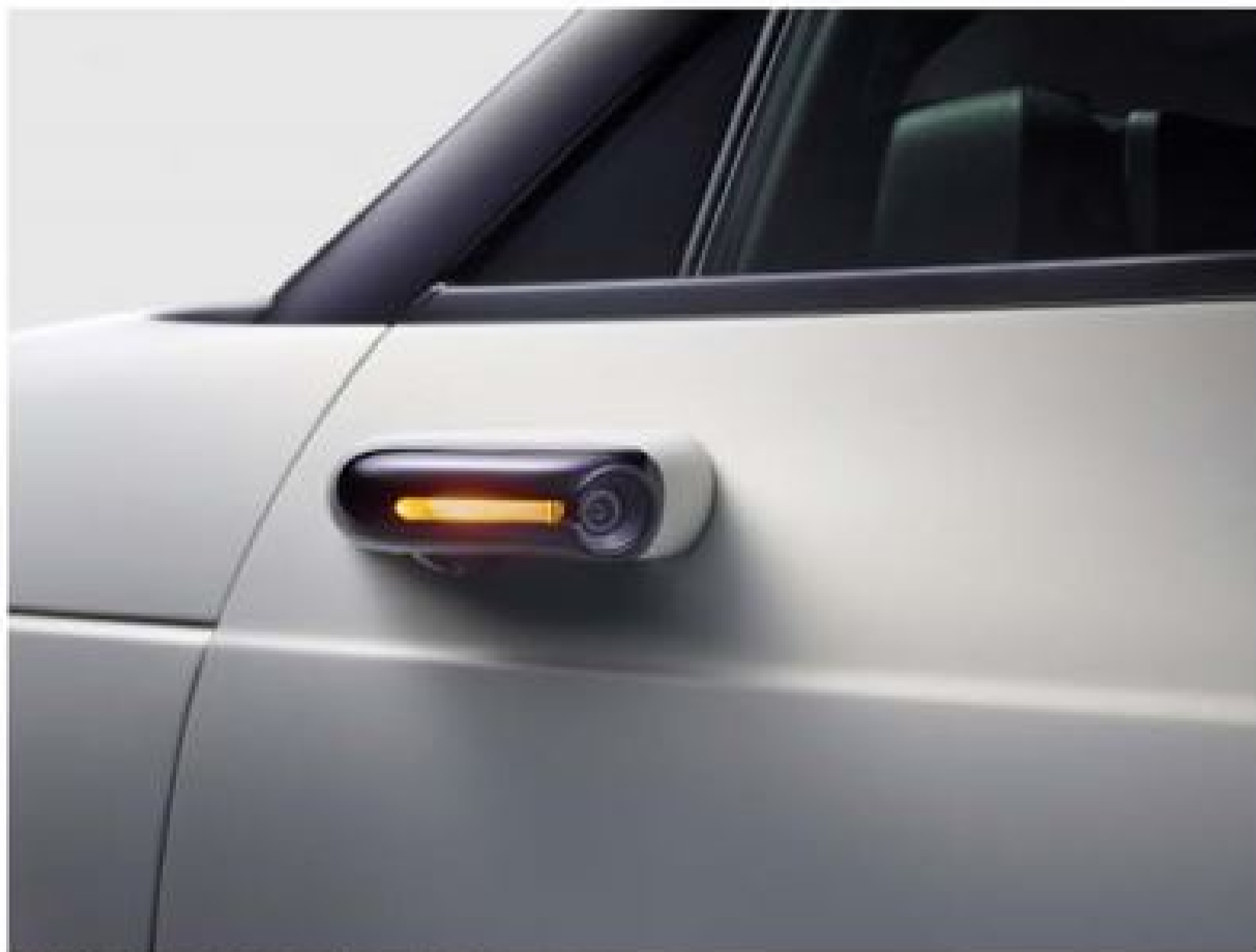
傳統後視鏡的位置採以 Side Camera Mirror System 數位鏡頭入替，並與方向燈整合為一體的設計，體積更加小型化。
