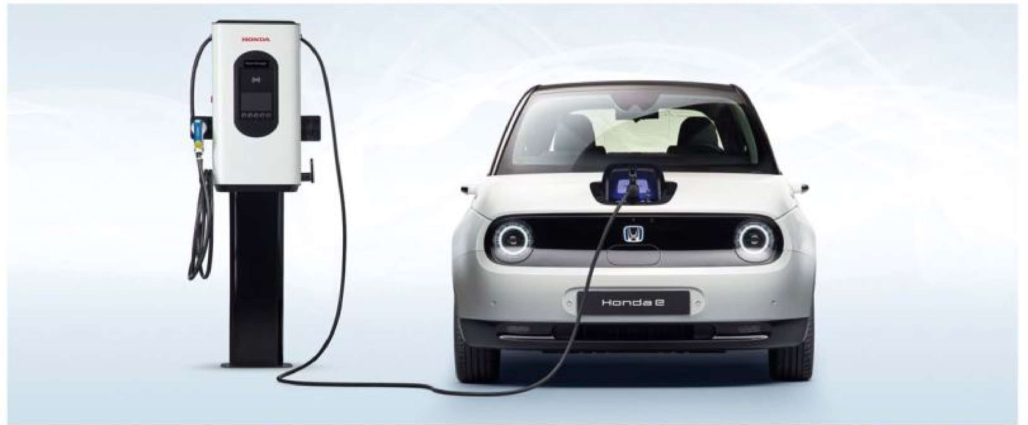
搭載水冷式 35.5kWh 鋰電池模組，Honda e 最大續航里程為 220km，在直流快速充電模式下則僅需半小時即可充至 80% 電量。
