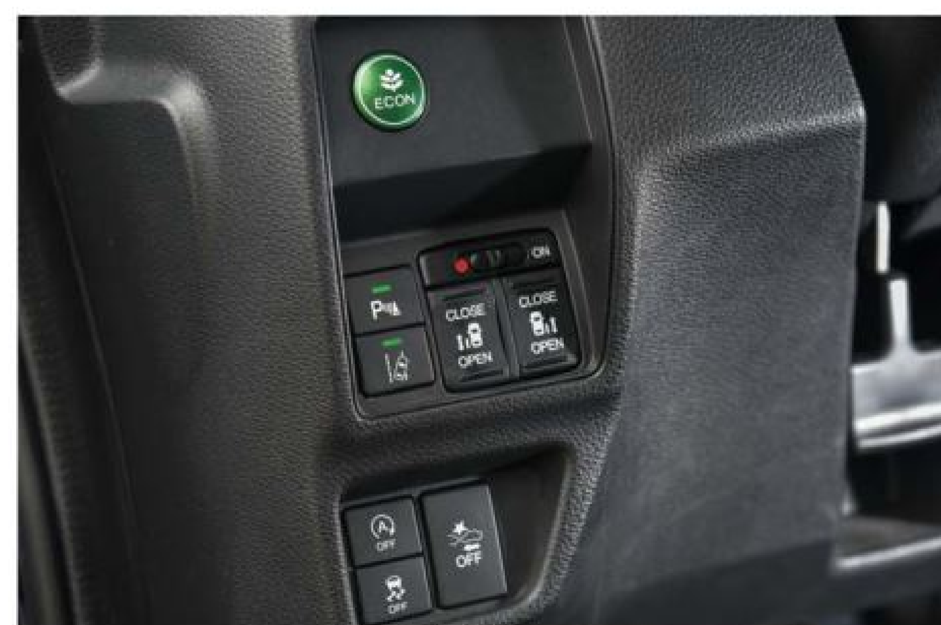
包括 FCW 前方碰撞警示系統、CMBS 碰撞緩解煞車系統、VSA 車身動態穩定系統、TPMS 胎壓異常警示系統與電動側滑門等機制，開關位於方向盤左下側的位置。
