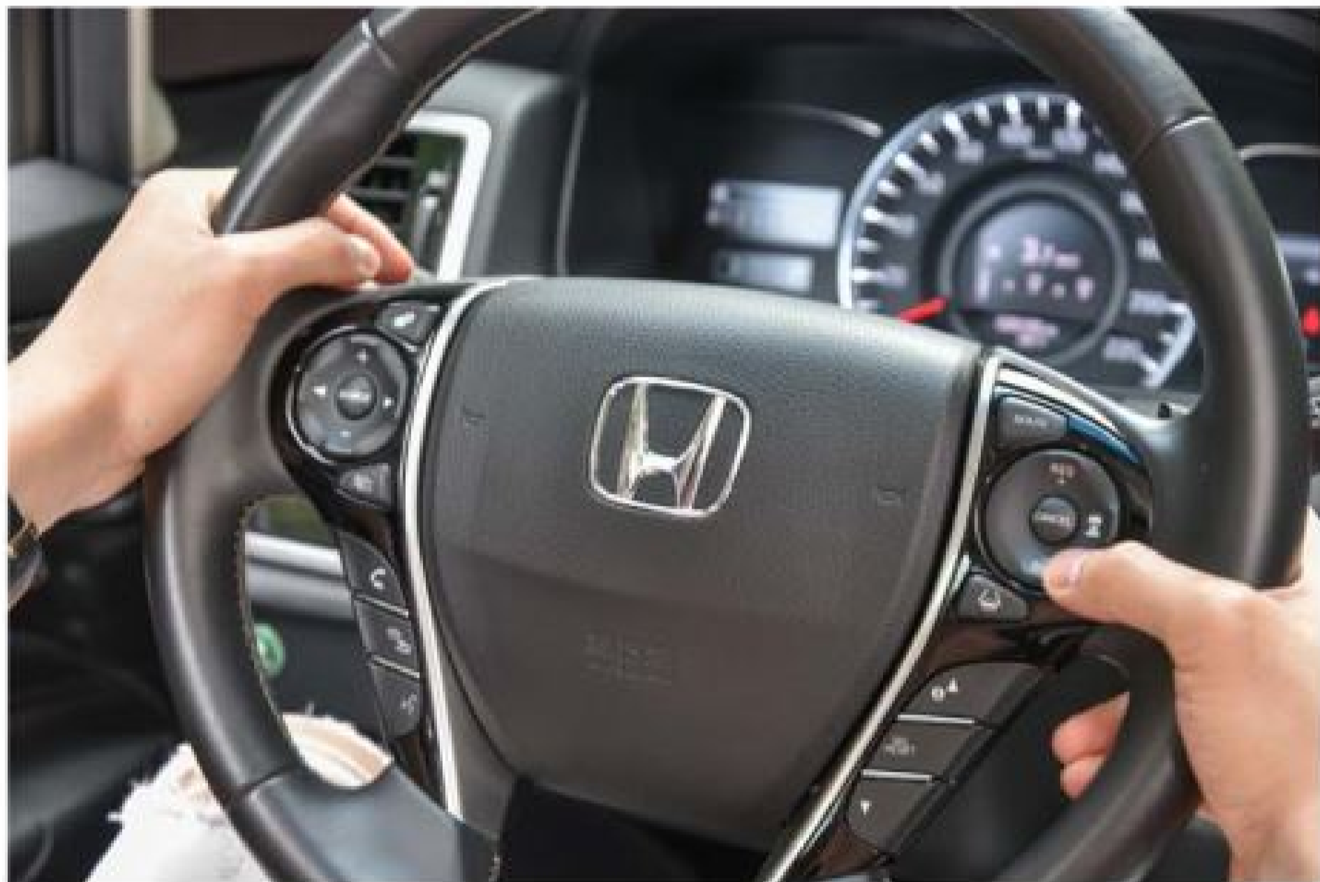
隸屬「Honda SENSING」智慧型安全主動防護系統的LKAS車道維持輔助系統與ACC主動式車距調節定速巡航系統，皆可於方向盤右側按鍵輕鬆啟閉與設定。
