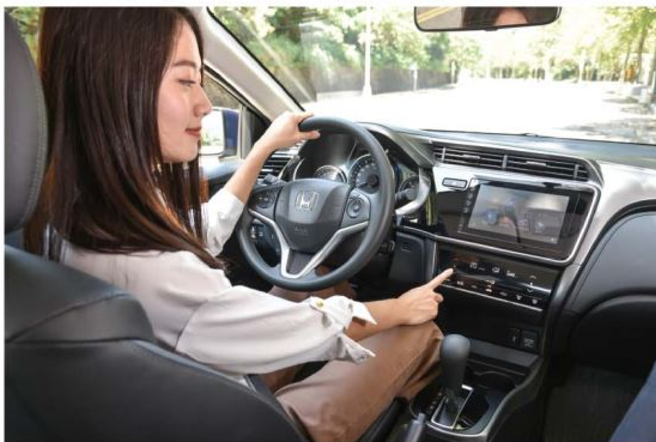
電容式觸控恆溫空調介面與多媒體螢幕，使用相當便利就手。
