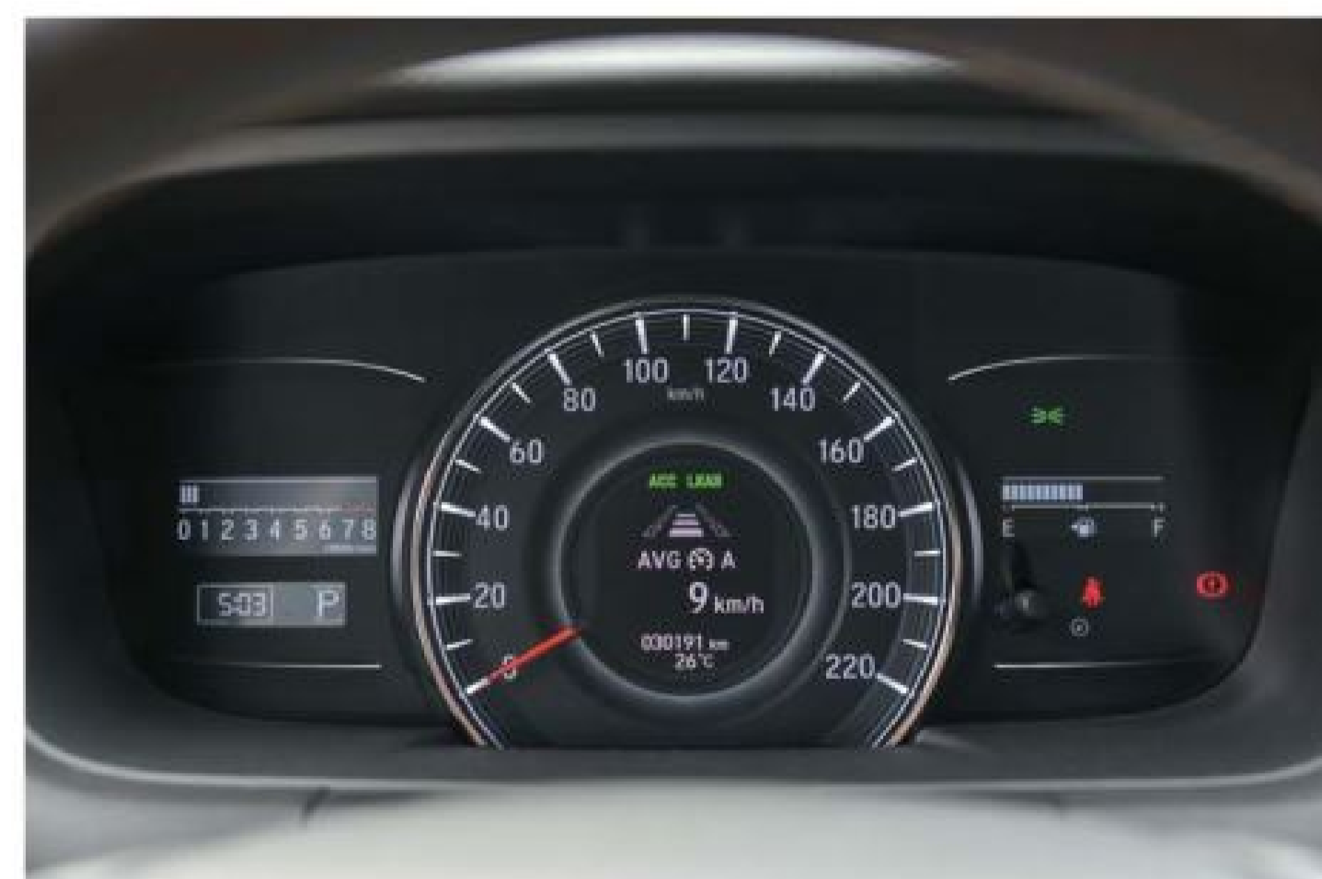
當設定完成後，儀錶中央螢幕會以文字與圖像顯示作動狀態。
