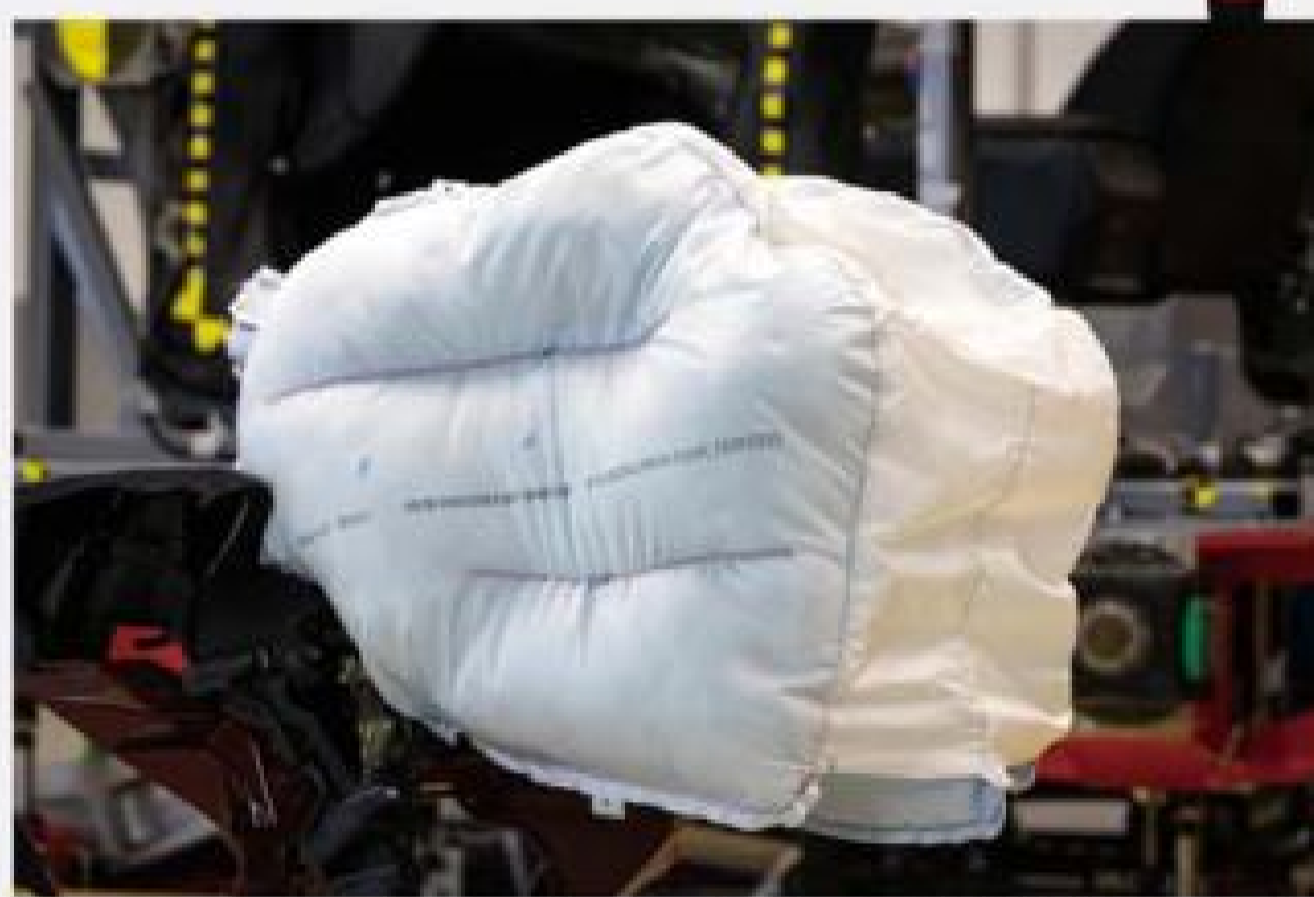
▲ Honda 與 Autoliv 合作研發的前乘客座新式安全氣囊由三個氣室組成。
