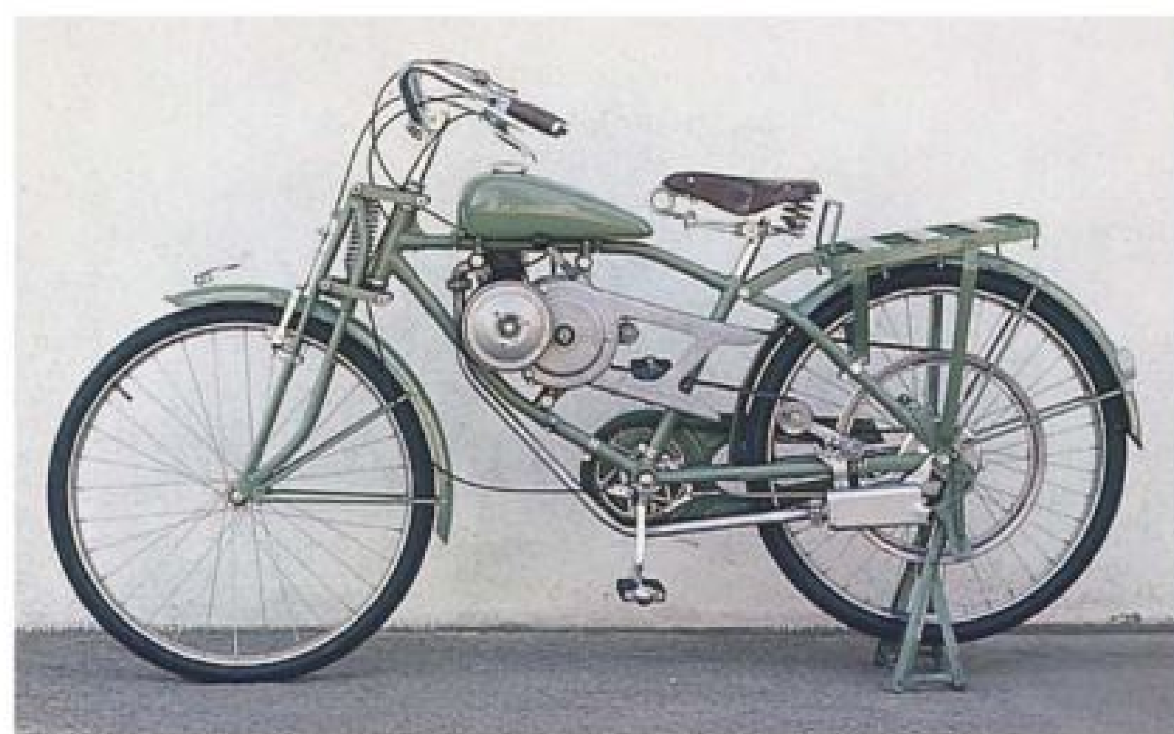
▲ Type-A引擎可提供自行車動力，成為後來輕型機車的雛形。
